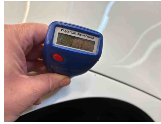
Lackstärke Seitenwand hinten rechts
