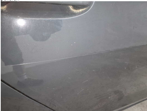
Beschädigung #1: Tür hinten rechts: Tür - Kratzer - auslegen / polieren
