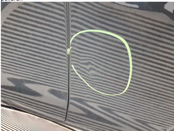
Beschädigung #2: Tür vorn rechts: Tür - Delle / Lackschaden - sanft instandsetzen
