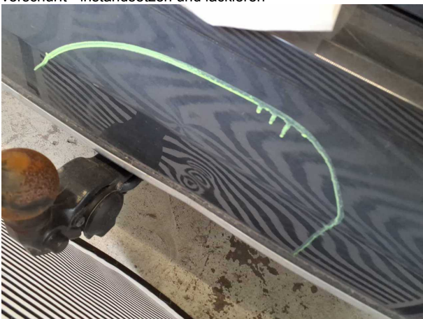
Beschädigung #9: Stossfänger vorn: Stossfänger vorn - verformt - erneuern
