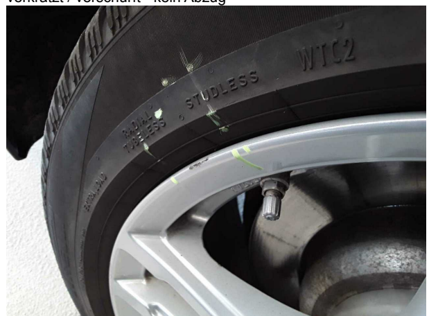
Beschädigung #3: Rad/Reifen: Leichtmetallfelge hinten rechts - verkratzt / verschürft - kein Abzug
