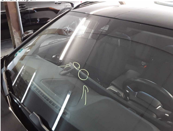
Beschädigung #7: Verglasung: Frontscheibe (Rissbildung) - Steinschlag - erneuern
