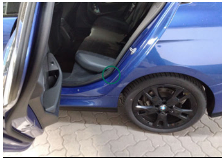
Türeinstieg / Hinten Links / Kratzer
