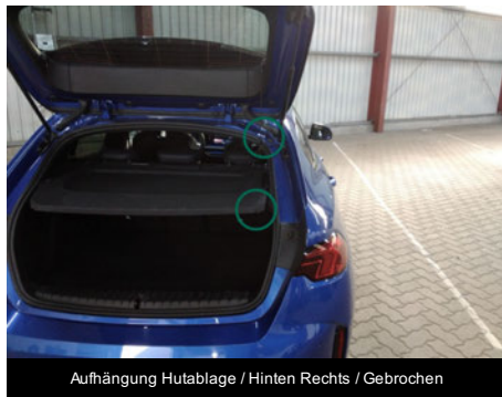
Aufhängung Hutablage / Hinten Rechts / Gebrochen
