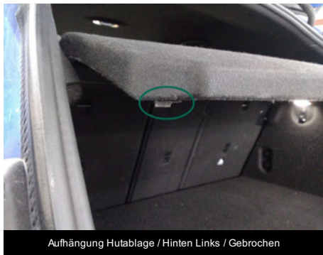
Aufhängung Hutablage / Hinten Links / Gebrochen
