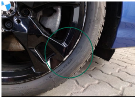
Felge / Vorne Rechts / Abgewetzt
