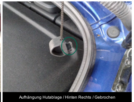
Aufhängung Hutablage / Hinten Rechts / Gebrochen
