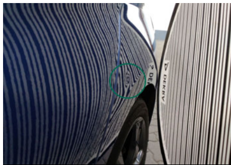
Seitenwand / Hinten Links / Delle
