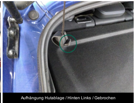
Aufhängung Hutablage / Hinten Links / Gebrochen
