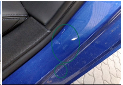
Türeinstieg / Hinten Links / Kratzer
