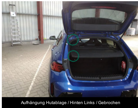
Aufhängung Hutablage / Hinten Links / Gebrochen
