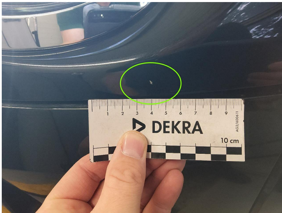
Bild 16 : Motorhaube, vereinzelt Steinschläge
