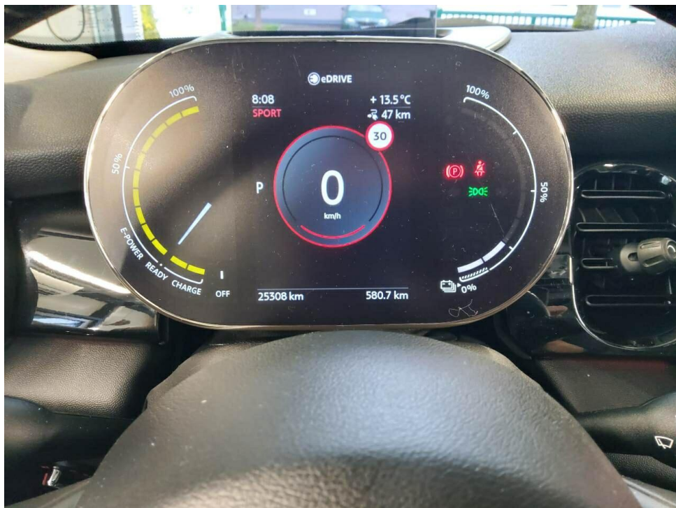
Bild 6 : Kombiinstrument (betriebsbereit) mit Km-Stand
