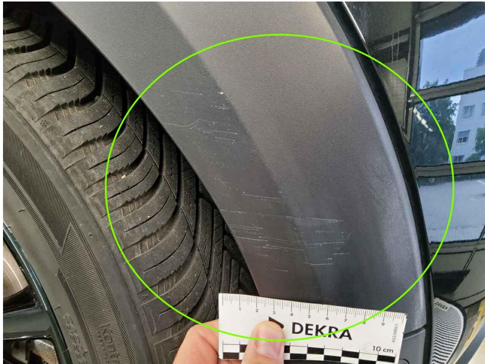
Bild 19 : Radlaufblende hinten links, zerkratzt
