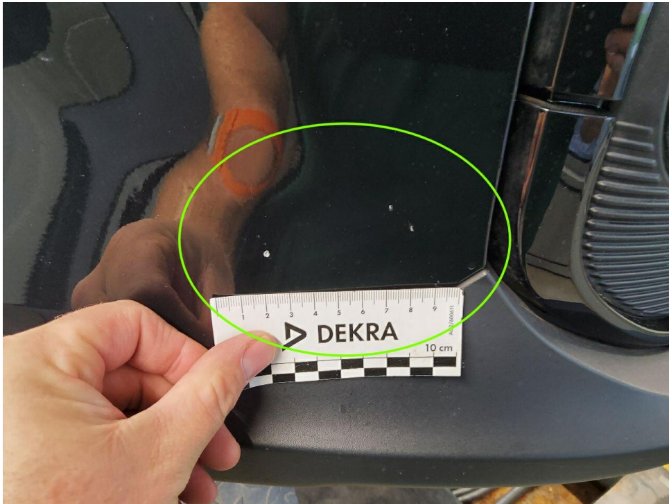
Bild 21 : Stoßfängerabdeckung vorne, vereinzelte Steinschläge
