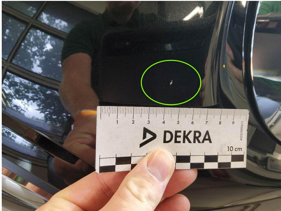
Bild 17 : Motorhaube, vereinzelt Steinschläge
