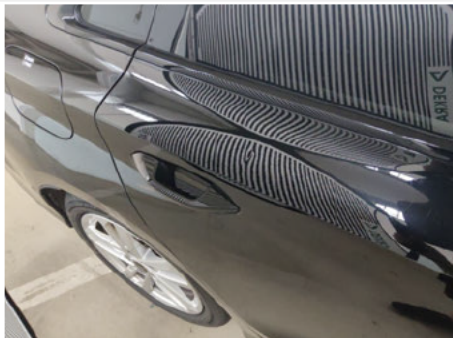
Tür / Hinten Rechts / Delle
