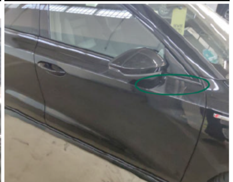
Tür / Vorne Rechts / Kratzer
