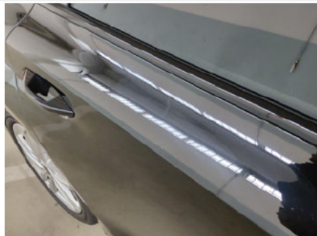
Tür / Hinten Rechts / Delle
