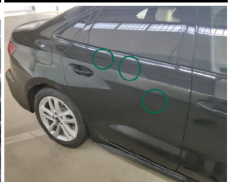
Tür / Hinten Rechts / Delle
