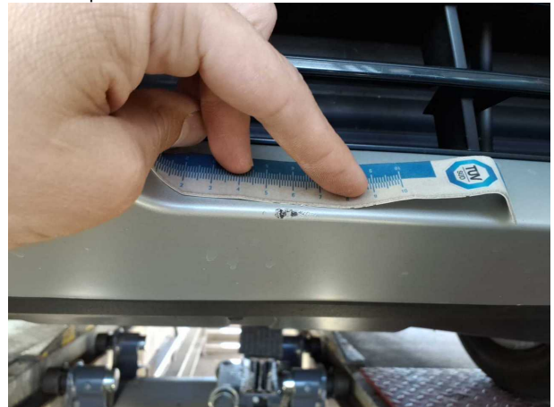
Beschädigung #2: Stossfänger vorn: Spoiler - Steinschlag - Smart Repair
