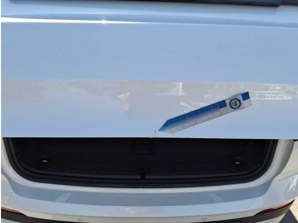
Beschädigung #1: Heckklappe/-tür: Heckklappe - Kratzer - Smart Repair
