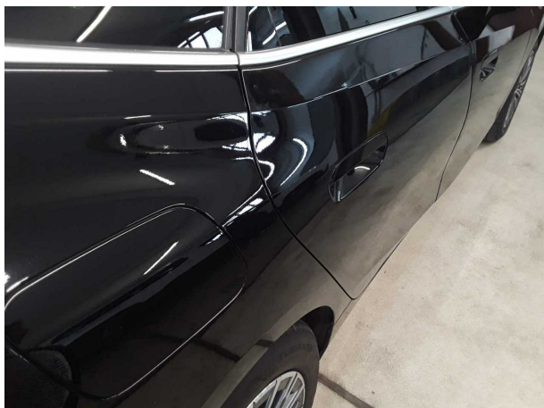
Beschädigung 1: Seitenwand rechts: Seitenwand - Delle(n) - sanft instandsetzen
