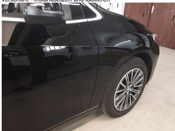
Beschädigung 5: Tür vorn rechts: Tür - verkratzt / verschürft - instandsetzen und lackieren
