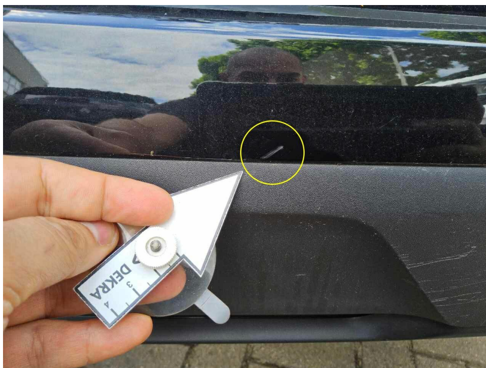
Bild 12 : Heckschürze hinten unten Lackierung, zerkratzt, polieren
