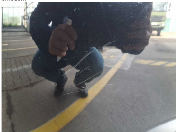
Beschädigung #9: Stossfänger hinten: Stossfänger hinten - Kratzer - lackieren
