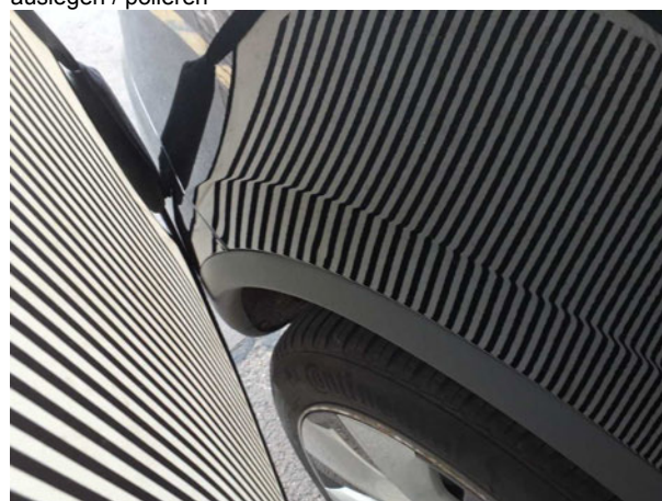
Beschädigung #3: Seitenwand rechts: Seitenwand - Delle(n) - sanft instandsetzen
