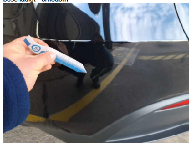
Beschädigung #9: Stossfänger hinten: Stossfänger hinten - Kratzer - lackieren
