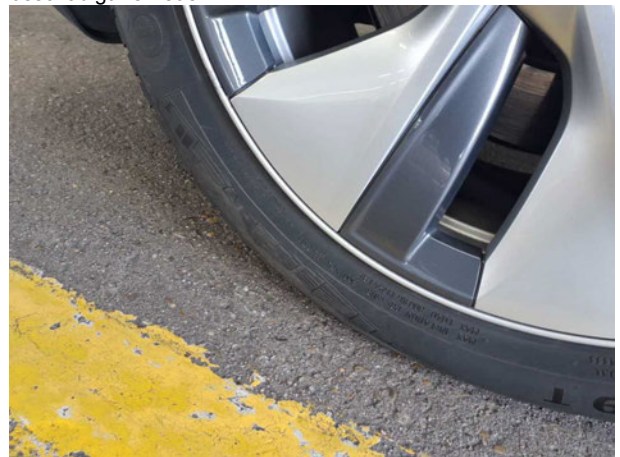
Beschädigung #11: Rad/Reifen: Leichtmetallfelge vorn links - beschädigt - erneuern
