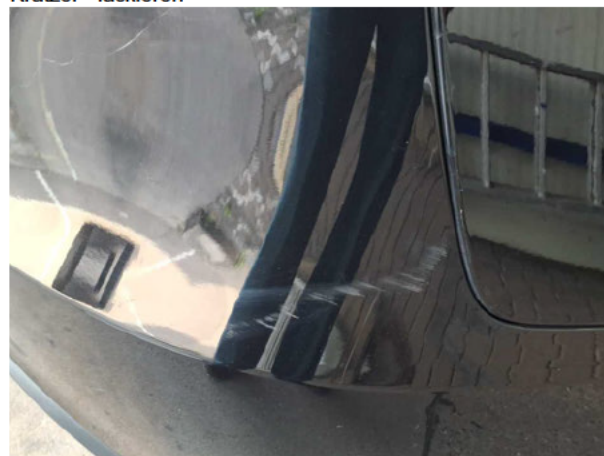
Beschädigung #9: Stossfänger hinten: Stossfänger hinten - Kratzer - lackieren
