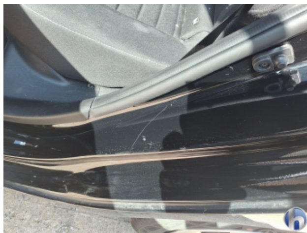
14. Türeinstieg Hinten - Links Kratzer - Smart Repair
