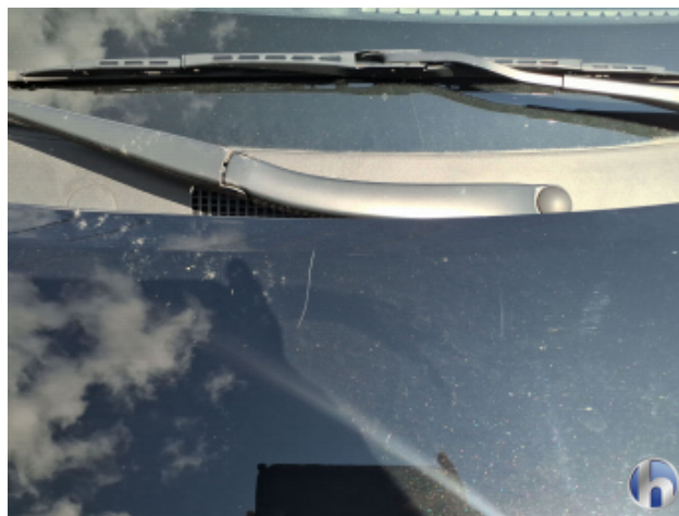
3. Motorhaube Kratzer - Lackieren
