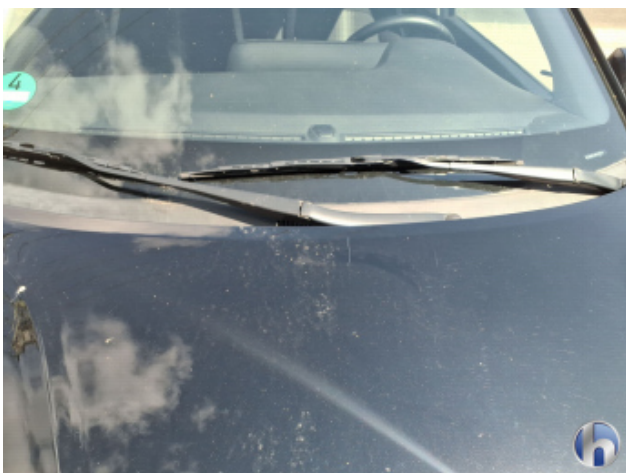
3. Motorhaube Kratzer - Lackieren
