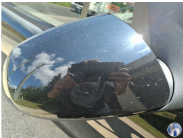
13. Außenspiegel Gehäuse - Rechts Kratzer - Smart Repair
