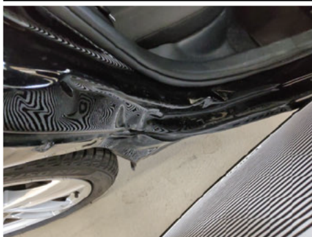
Türeinstieg / Hinten Rechts / Delle
