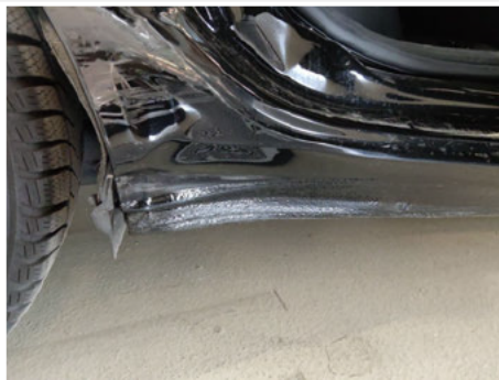
Schweller / Hinten Rechts / Delle
