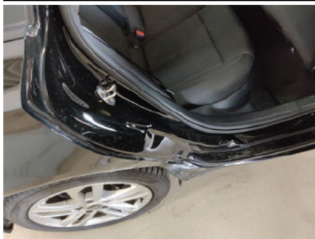
Türeinstieg / Hinten Rechts / Delle
