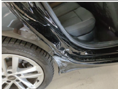
Türeinstieg / Hinten Rechts / Delle
