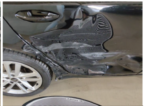
Tür / Hinten Rechts / Delle
