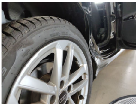
Radhausschale H / Hinten Rechts / Gebrochen
