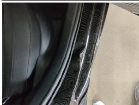
Türeinstieg / Hinten Rechts / Delle
