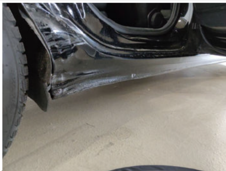
Schweller / Hinten Rechts / Delle
