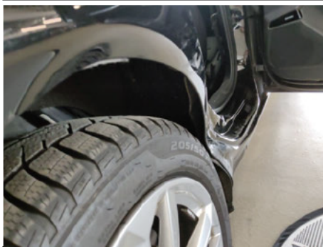
Radhausschale H / Hinten Rechts / Gebrochen
