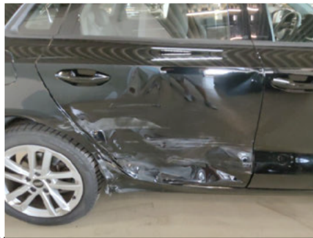
Tür / Hinten Rechts / Delle
