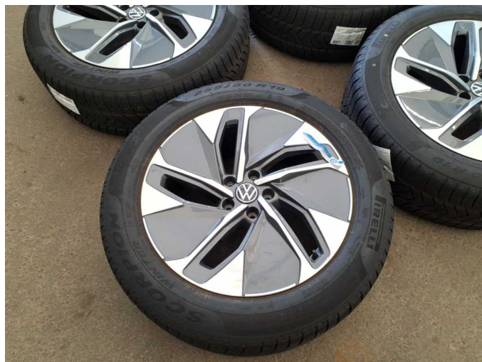
Damage 3: 2nd wheel set: 1 alloy rim (Materialveränderung an Glanzgedrehter Stelle) - Corrosion - Loss in value
