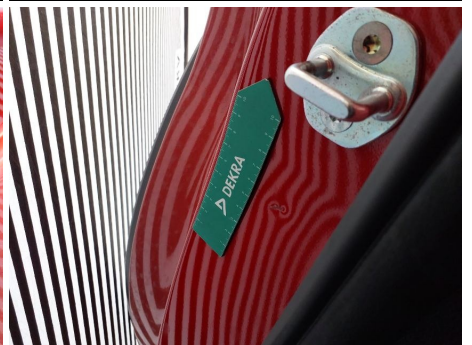
Türeinstieg / Hinten Rechts / Delle
