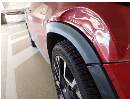
Kotflügelzierleiste / Rechts / Gebrochen
