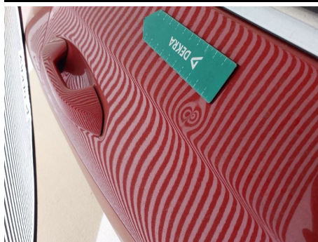
Tür / Hinten Rechts / Delle
