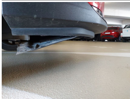
Unterfahrschutz / Vorne / Gebrochen
