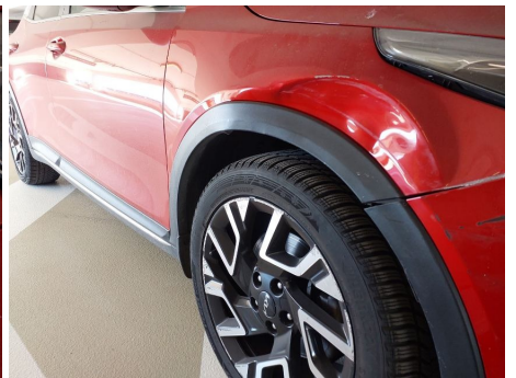
Kotflügelzierleiste / Rechts / Gebrochen
