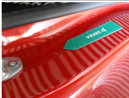
Türeinstieg / Hinten Rechts / Delle
