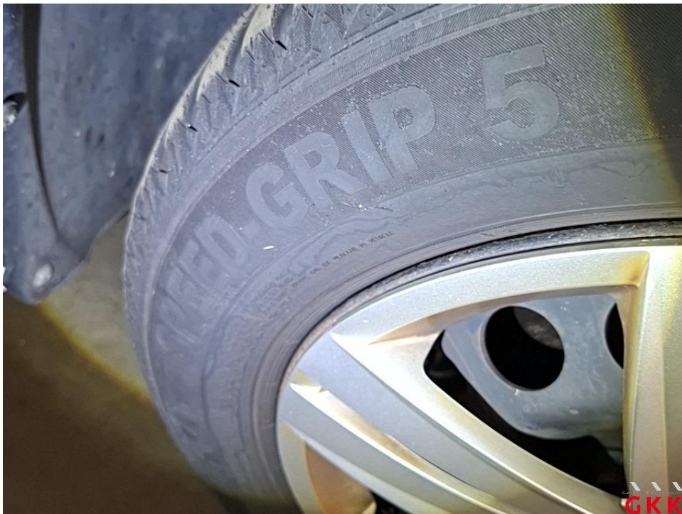
Bild 18 Reifen, vorn links und rechts, falsche Reifenart, ersetzen
