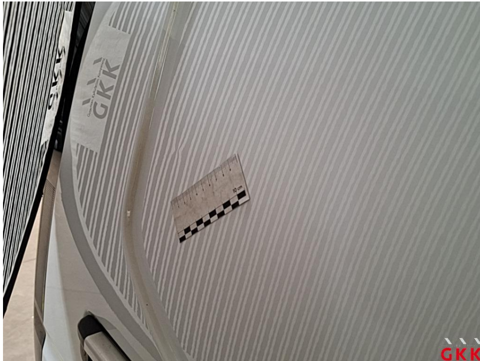
Bild 29 Seitenwand rechts, hinten -oberhalb-, beschädigt, instand setzen - lackieren
