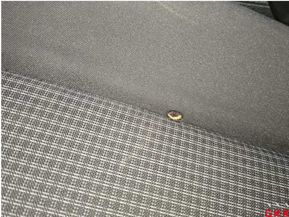
Bild 17 Sitz vorne links, Bezug Sitzkissen -Stoff-, Brandloch, ersetzen
