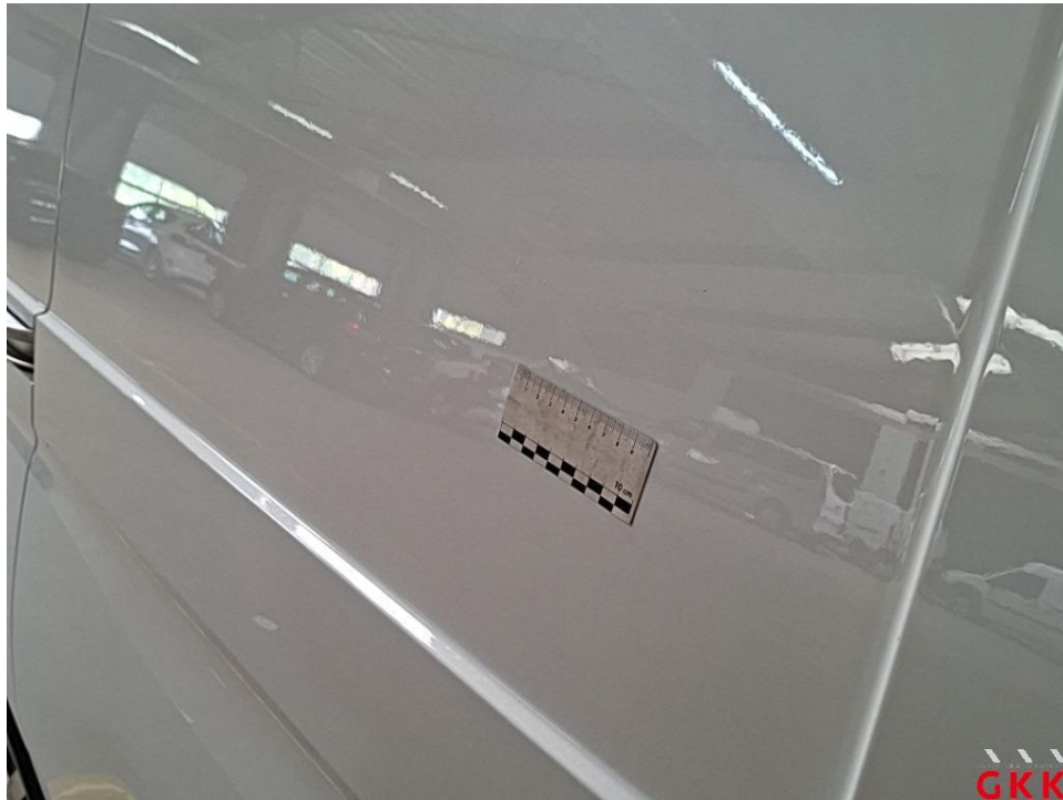
Bild 31 Schiebetür rechts, beschädigt, instand setzen - lackieren
