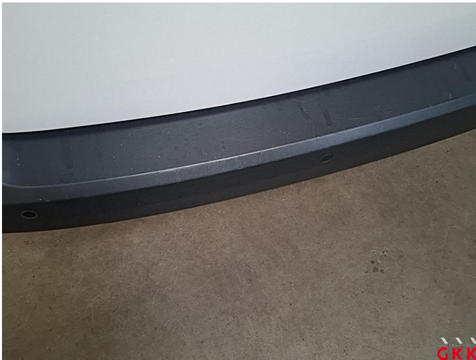
Bild 26 Stoßfänger hinten, Verkleidung -unlackiert-, verkratzt, Smartrepair
