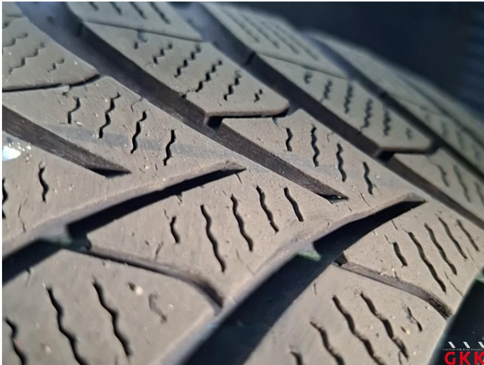
Bild 19 Reifen, vorn links und rechts, falsche Reifenart, ersetzen
