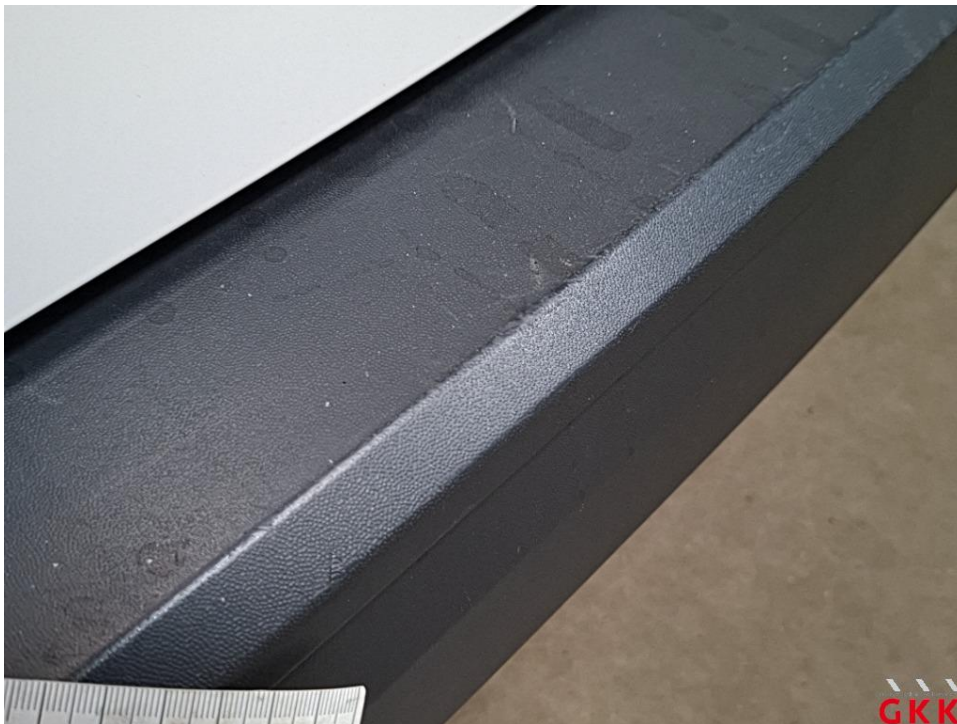
Bild 28 Stoßfänger hinten, Verkleidung -unlackiert-, verkratzt, Smartrepair
