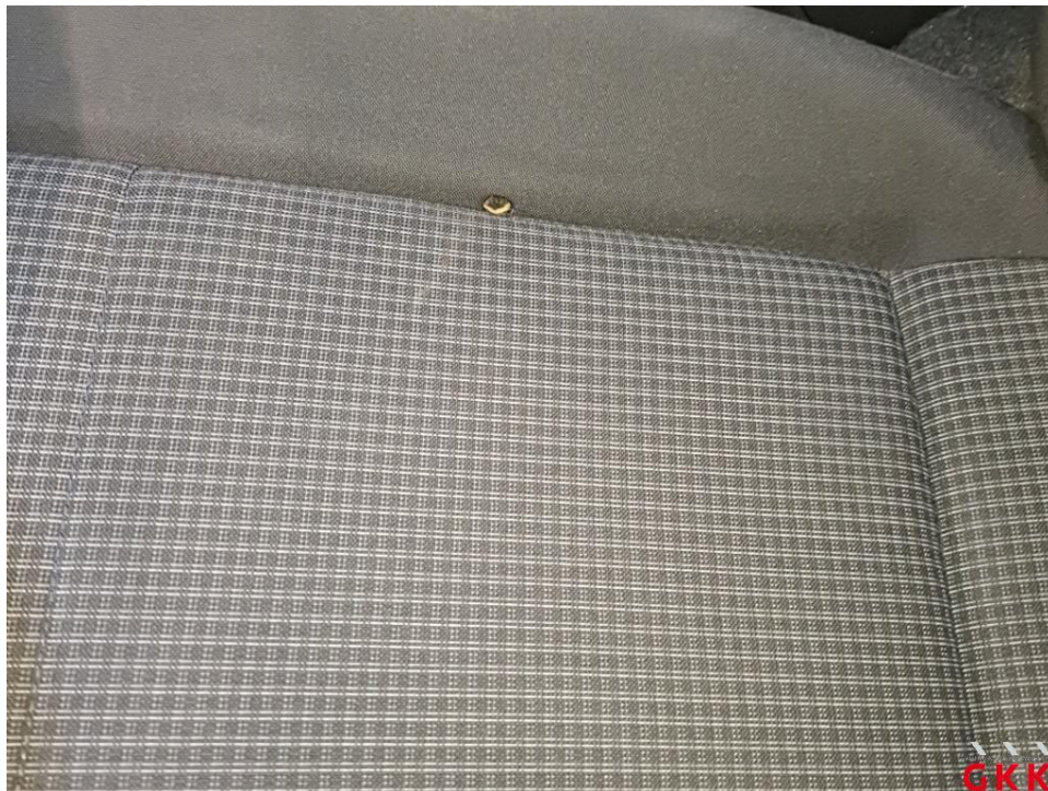
Bild 16 Sitz vorne links, Bezug Sitzkissen -Stoff-, Brandloch, ersetzen
