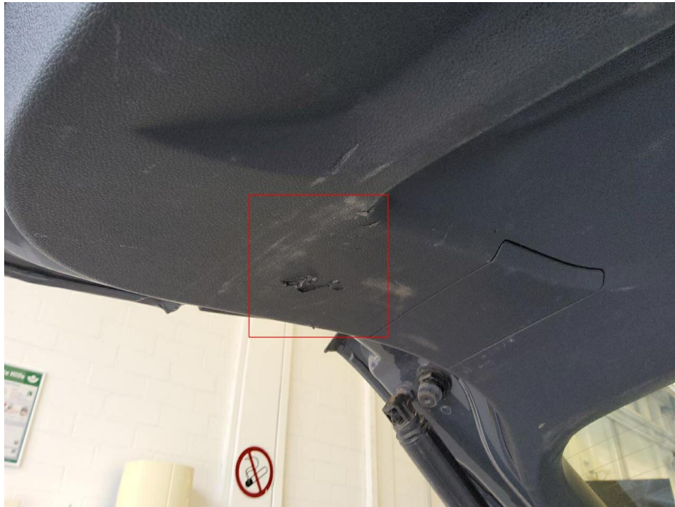
Bild 28 : Heckklappe innen verschrammt
