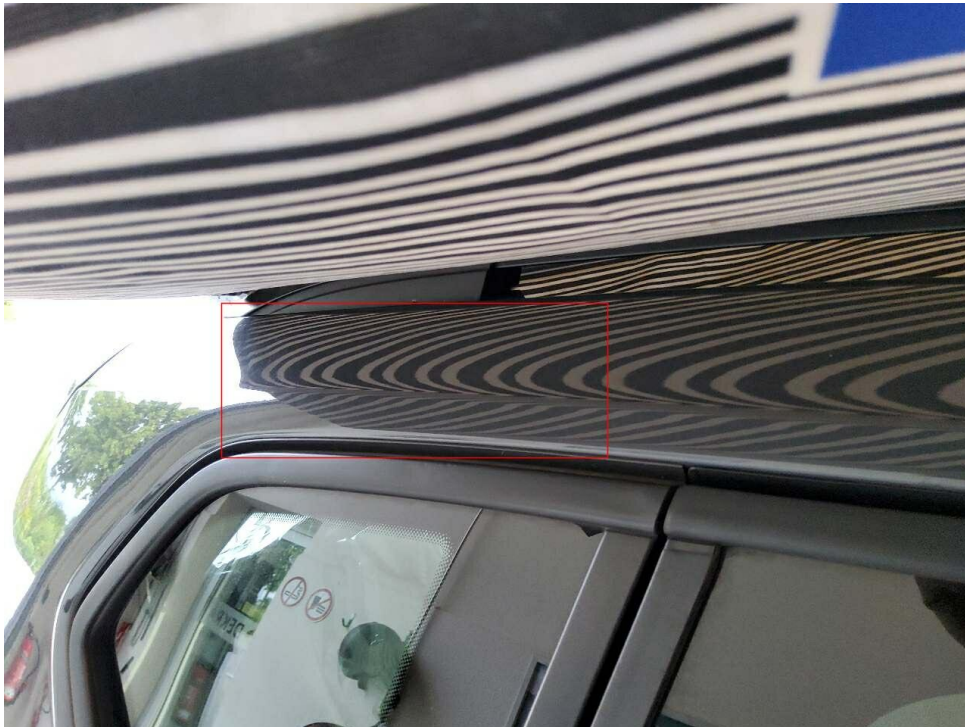
Bild 22 : Seitenteil hinten rechts, eingedellt, drücken
