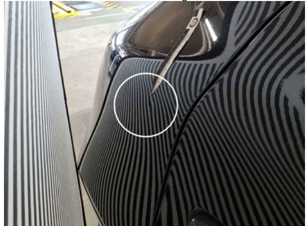
Beschädigung #2: Seitenwand rechts: Seitenwand - Delle(n) - sanft instandsetzen
