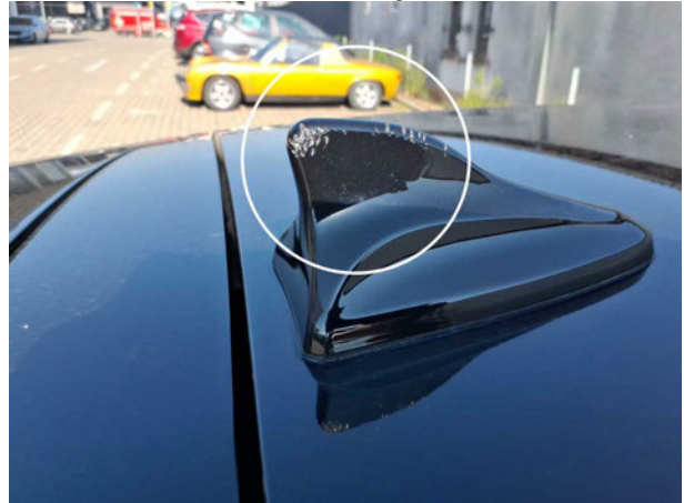
Beschädigung #6: Fahrzeugdach: Antennenstab - beschädigt - erneuern
