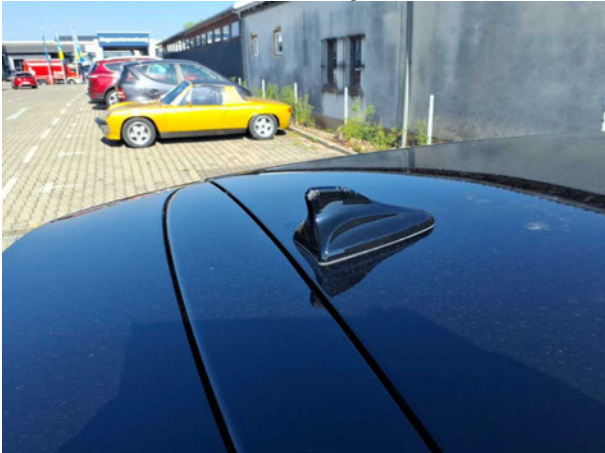
Beschädigung #6: Fahrzeugdach: Antennenstab - beschädigt - erneuern
