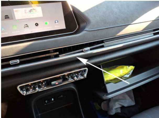
Beschädigung #8: Instrumententafel: Luftdüse Mitte - gebrochen / gerissen - erneuern
