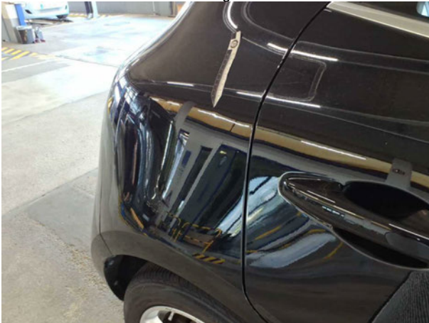
Beschädigung #2: Seitenwand rechts: Seitenwand - Delle(n) - sanft instandsetzen
