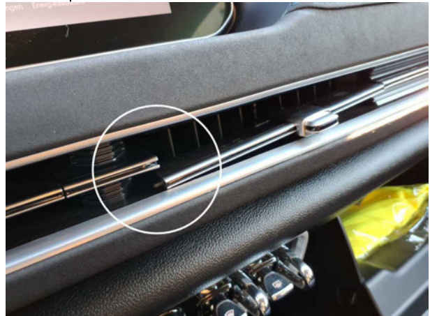
Beschädigung #8: Instrumententafel: Luftdüse Mitte - gebrochen / gerissen - erneuern
