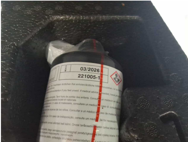
Beschädigung #1: Ausrüstung: Tirefit Füllmittel - abgelaufen - erneuern
