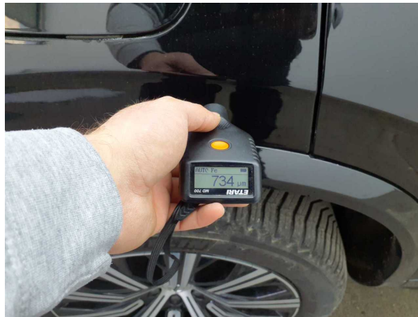
Nachlackierung 2: Seitenwand rechts
