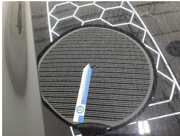
Beschädigung #1: Motorhaube: Motorhaube - Delle(n) - sanft instandsetzen
