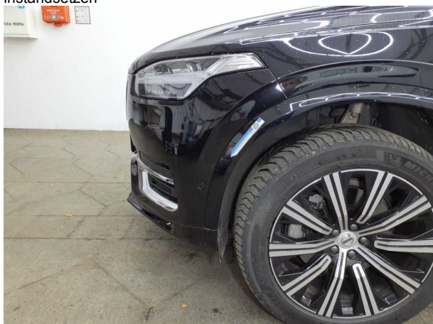
Beschädigung #2: Kotflügel links: Radlauf (Lacknebel) - Kratzer - Smart Repair
