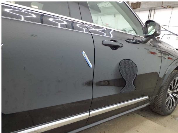
Beschädigung #6: Tür hinten rechts: Tür - Kratzer - Smart Repair
