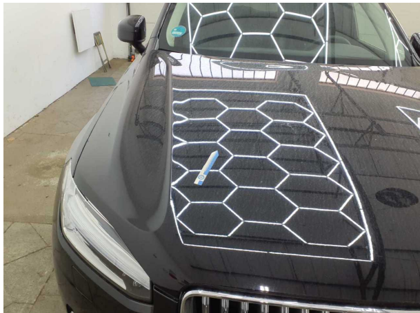
Beschädigung #1: Motorhaube: Motorhaube - Delle(n) - sanft instandsetzen
