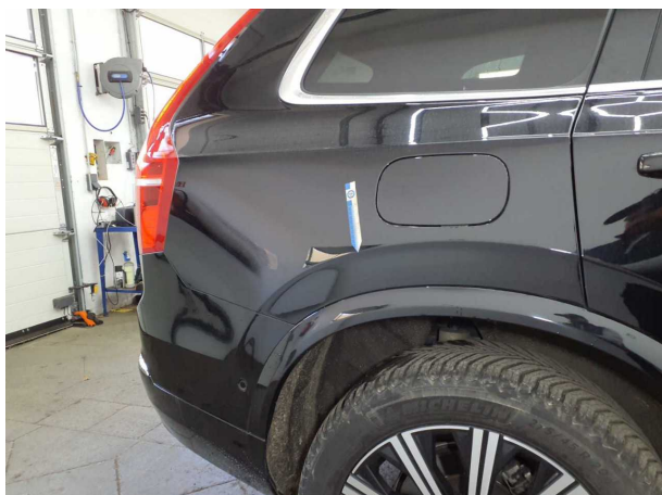
Beschädigung #7: Seitenwand rechts: Seitenwand - nicht fachgerecht instandgesetzt - instandsetzen und lackieren
