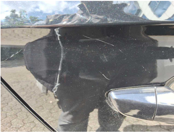
Beschädigung #6: Tür hinten rechts: Tür - Kratzer - lackieren
