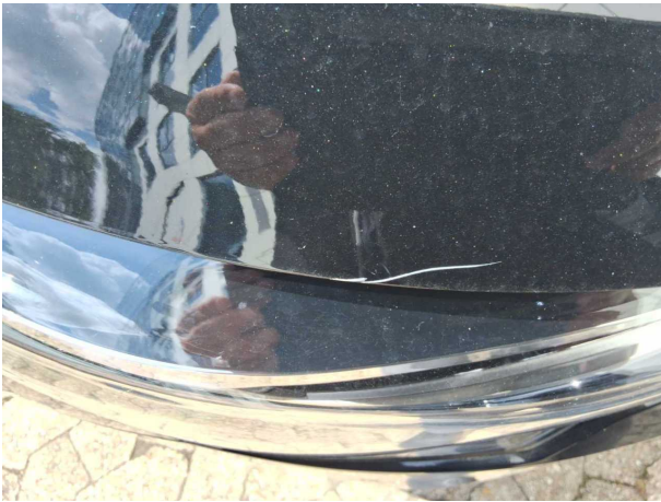
Beschädigung #8: Motorhaube: Motorhaube - Kratzer - lackieren
