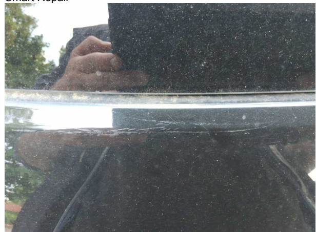
Beschädigung #3: Heckklappe/-tür: Heckklappe - Kratzer - Smart Repair
