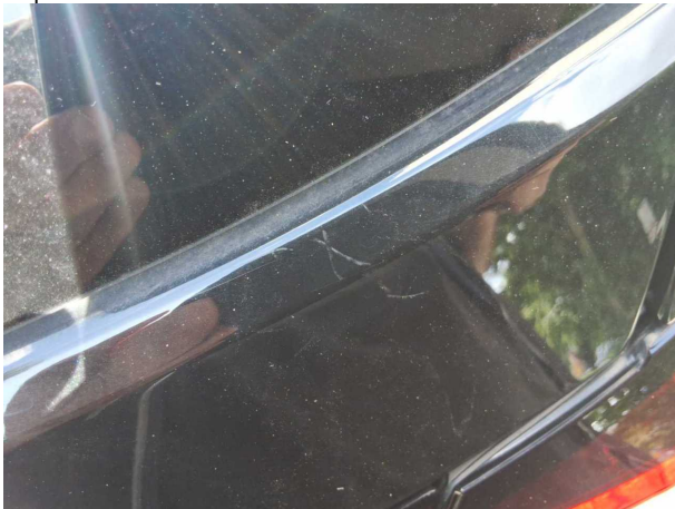
Beschädigung #3: Heckklappe/-tür: Heckklappe - Kratzer - Smart Repair
