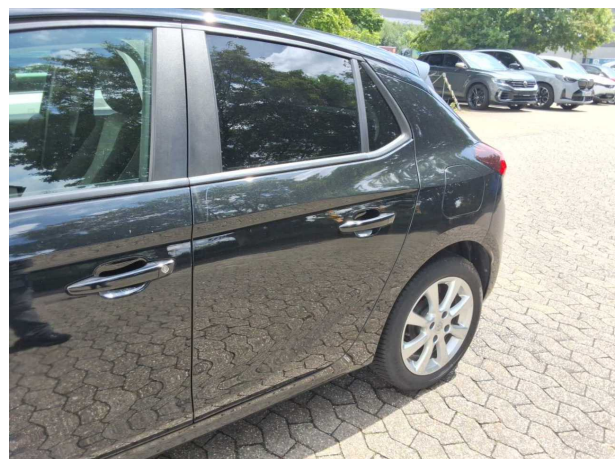
Beschädigung #7: Tür hinten links: Tür - Kratzer - lackieren
