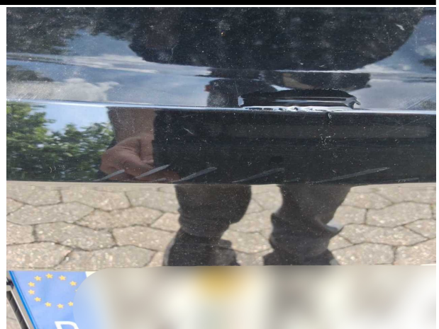
Beschädigung #9: Stossfänger hinten: Stossfänger hinten - Kratzer - lackieren
