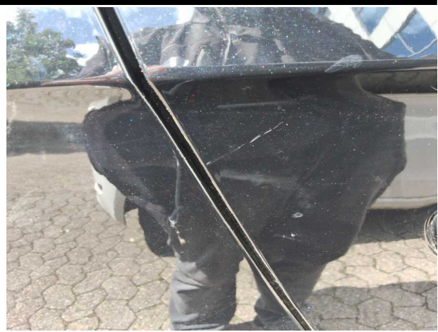
Beschädigung #6: Tür hinten rechts: Tür - Kratzer - lackieren
