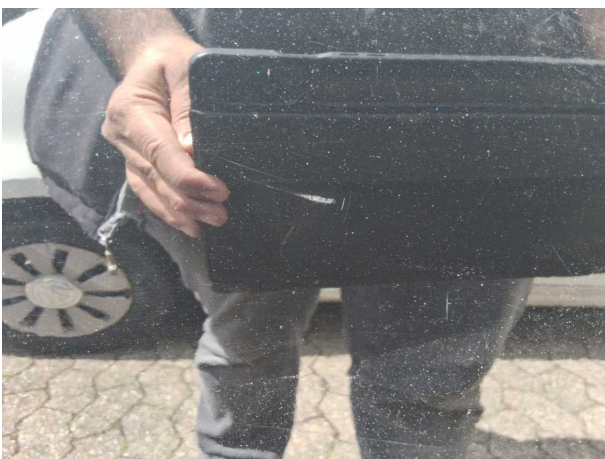
Beschädigung #6: Tür hinten rechts: Tür - Kratzer - lackieren
