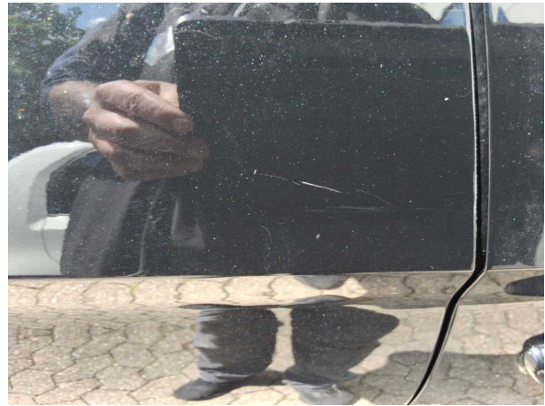
Beschädigung #6: Tür hinten rechts: Tür - Kratzer - lackieren
