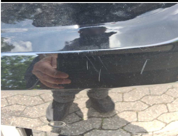
Beschädigung #9: Stossfänger hinten: Stossfänger hinten - Kratzer - lackieren
