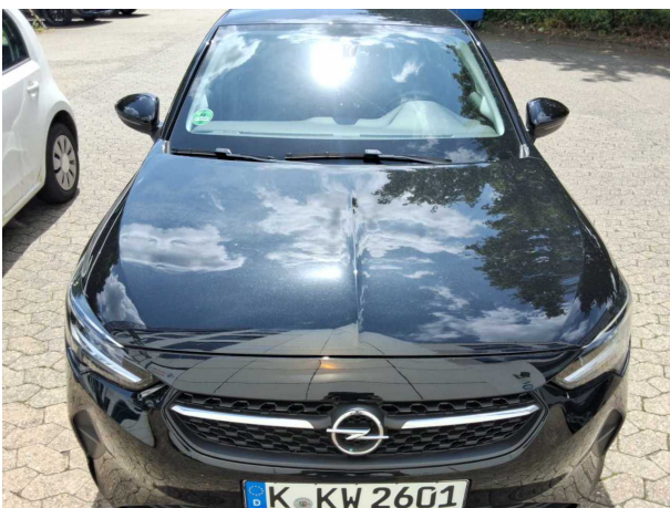
Beschädigung #8: Motorhaube: Motorhaube - Kratzer - lackieren
