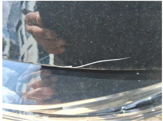
Beschädigung #8: Motorhaube: Motorhaube - Kratzer - lackieren
