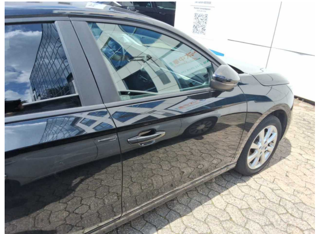
Beschädigung #10: Tür vorn rechts: Tür - Kratzer - lackieren
