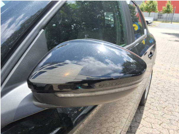
Beschädigung #2: Außenspiegel links: Abdeckkappe - Kratzer - Smart Repair
