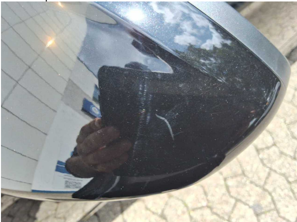
Beschädigung #2: Außenspiegel links: Abdeckkappe - Kratzer - Smart Repair
