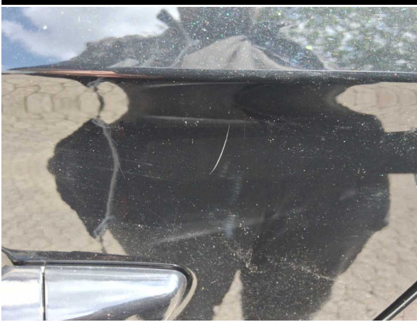
Beschädigung #7: Tür hinten links: Tür - Kratzer - lackieren
