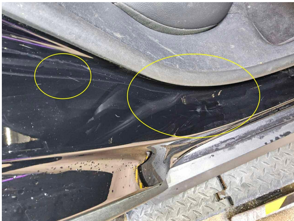
Bild 16 : Tür hinten rechts Einstieg, zerkratzt, smart repair
