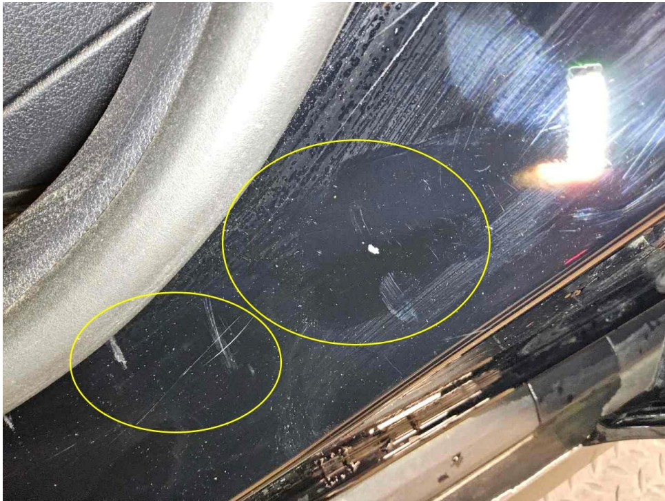
Bild 19 : Tür vorne links Einstieg, zerkratzt, smart repair
