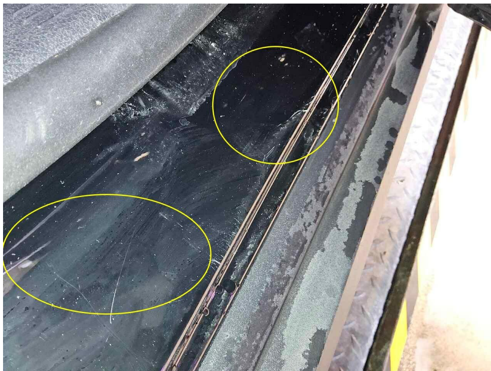
Bild 15 : Tür hinten rechts Einstieg, zerkratzt, smart repair
