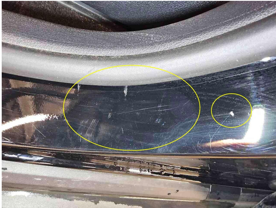
Bild 17 : Tür vorne links Einstieg, zerkratzt, smart repair
