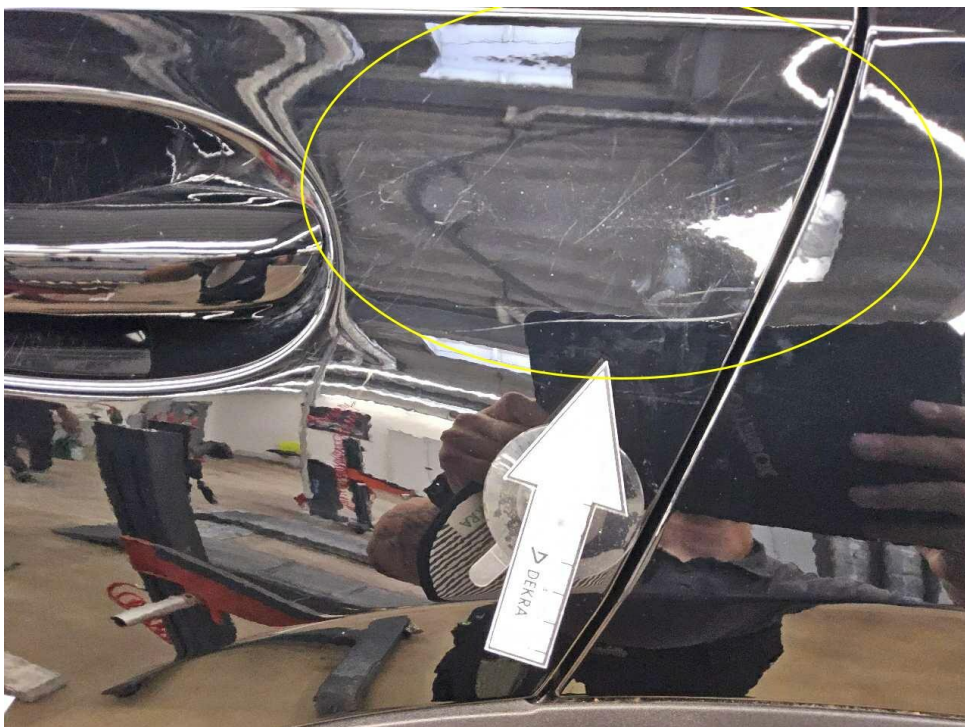
Bild 20 : Tür hinten links Lackierung, zerkratzt, smart repair
