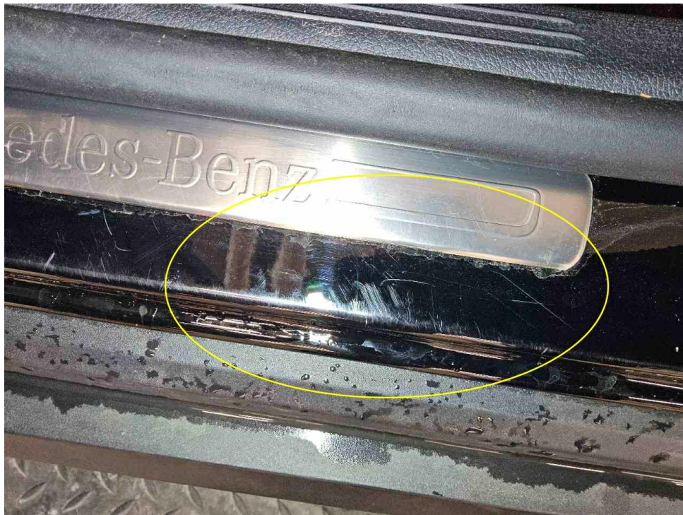
Bild 18 : Tür vorne links Einstieg, zerkratzt, smart repair
