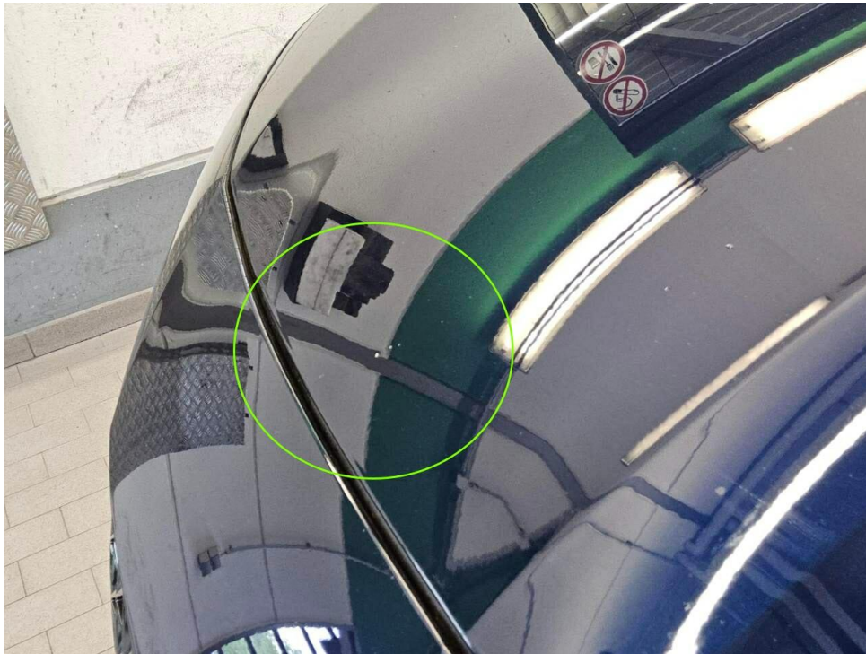
Bild 15 : Motorhaube, eingedellt, Gebrauchsspur
