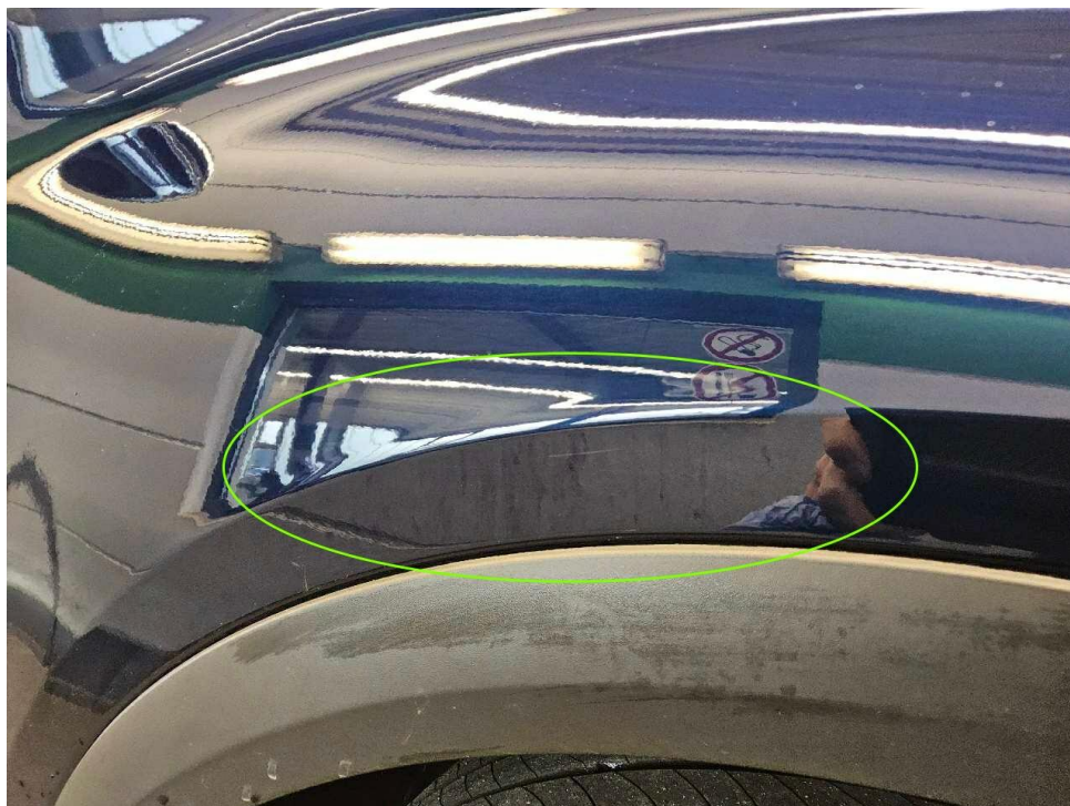
Bild 20 : Oberflächenkratzer an mehreren Bauteilen
