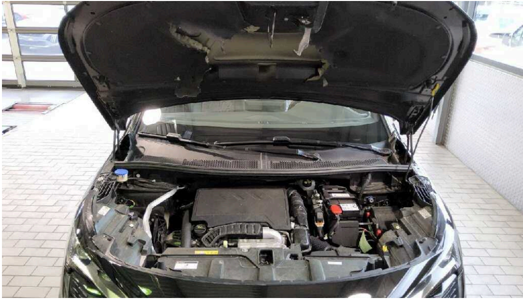
Bild 17 Fahrzeugfront Dämmung Motorhaube
