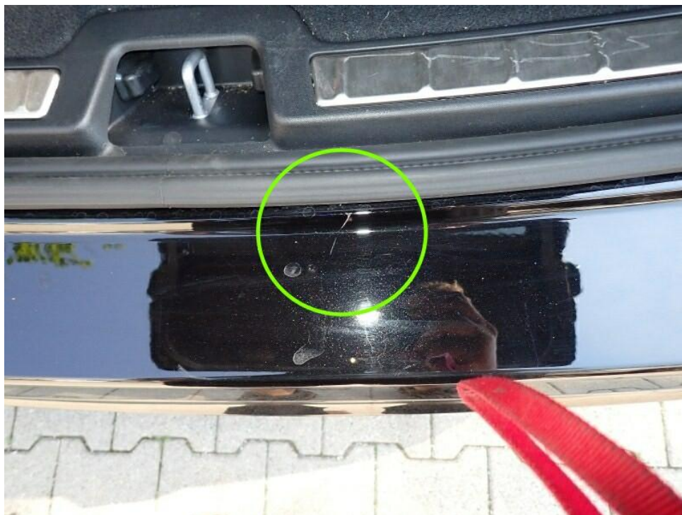
Bild 13 : Ladekante Stoßfänger hinten Kratzer
