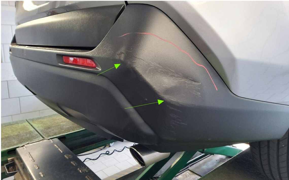
Bild 19 : Verkleidung Stoßfänger hinten mehrfach angefahren
