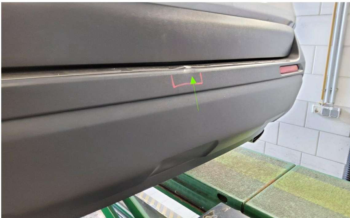
Bild 18 : Verkleidung Stoßfänger hinten mehrfach angefahren
