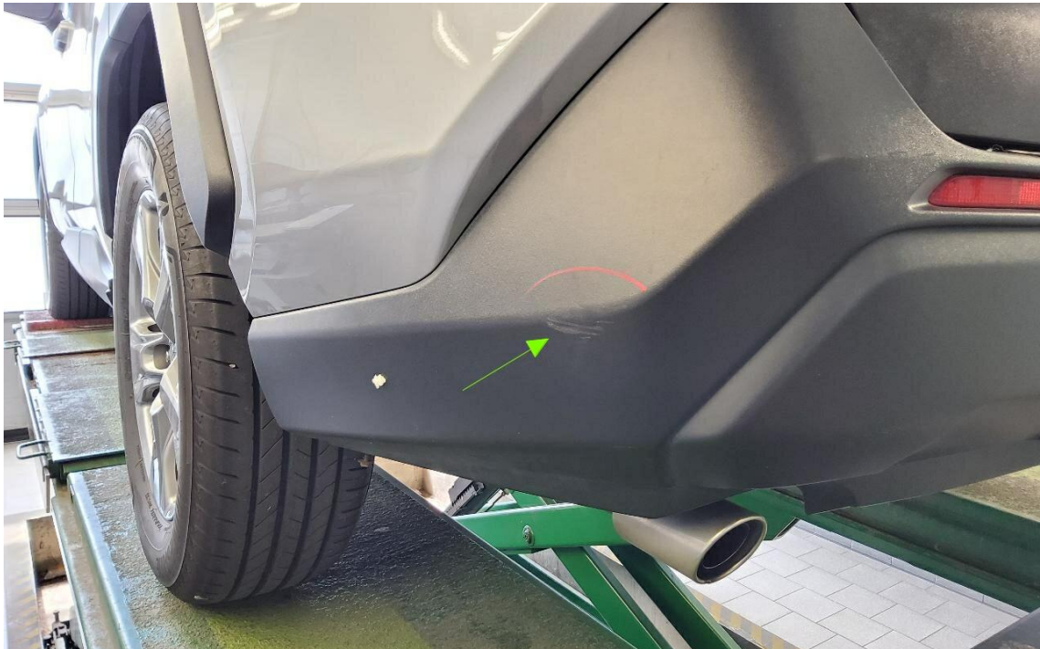
Bild 17 : Verkleidung Stoßfänger hinten mehrfach angefahren
