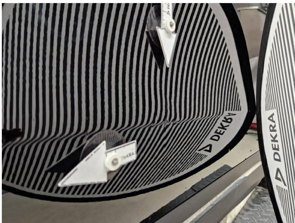
Bild 26 : Tür vorne rechts, mehrfach eingedellt, instandsetzen und lackieren mit Lackaufbau
