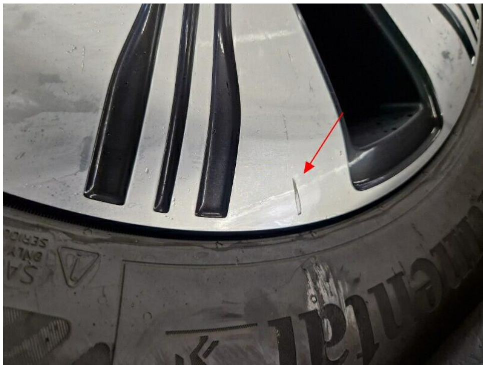
Bild 17 : Glanzgedrehte SR-Felge HR verschrammt
