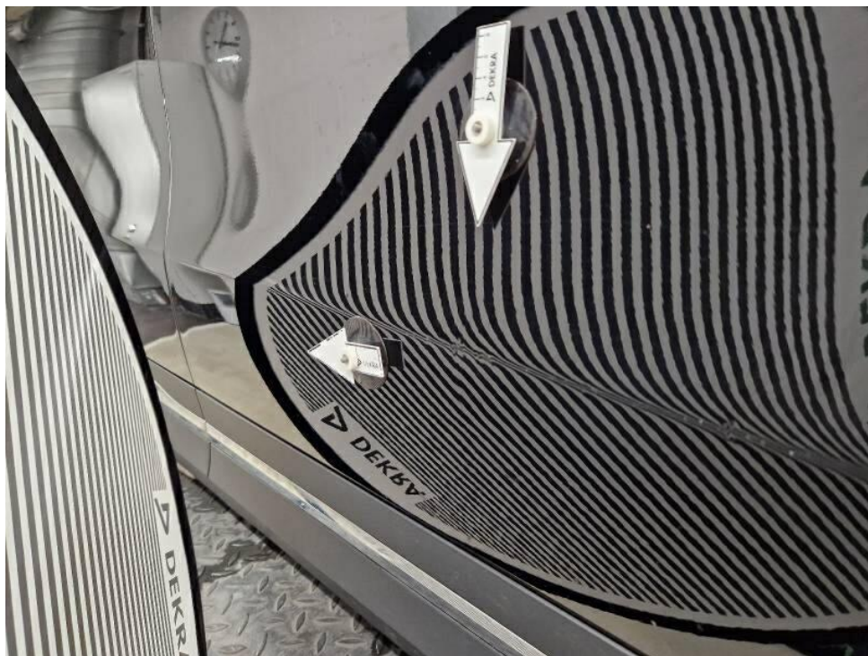
Bild 28 : Tür vorne rechts, mehrfach eingedellt, instandsetzen und lackieren mit Lackaufbau
