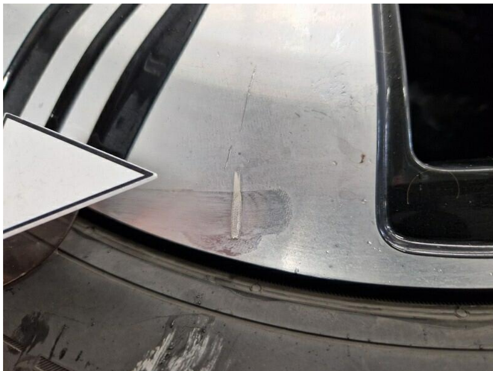
Bild 18 : Glanzgedrehte SR-Felge HR verschrammt
