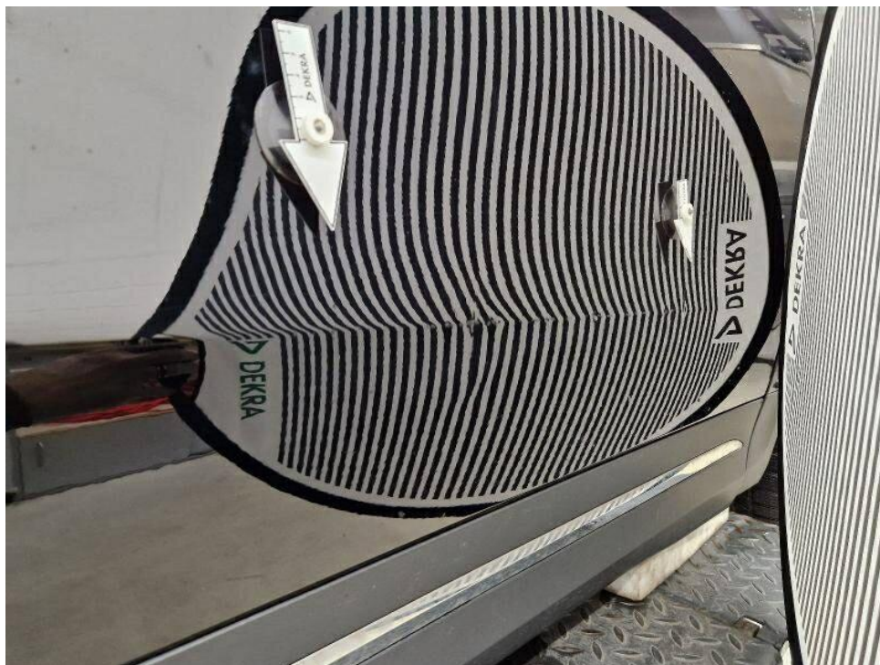
Bild 25 : Tür vorne rechts, mehrfach eingedellt, instandsetzen und lackieren mit Lackaufbau
