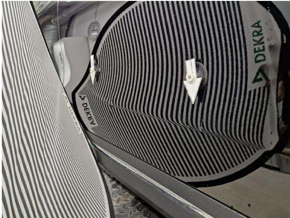
Bild 27 : Tür vorne rechts, mehrfach eingedellt, instandsetzen und lackieren mit Lackaufbau
