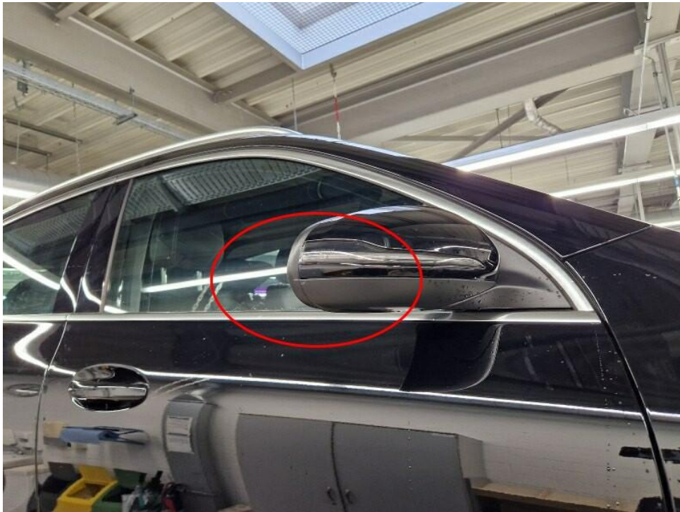
Bild 29 : ASP rechts Gehäuse verschrammt ASP rechts Rahmen verschrammt
