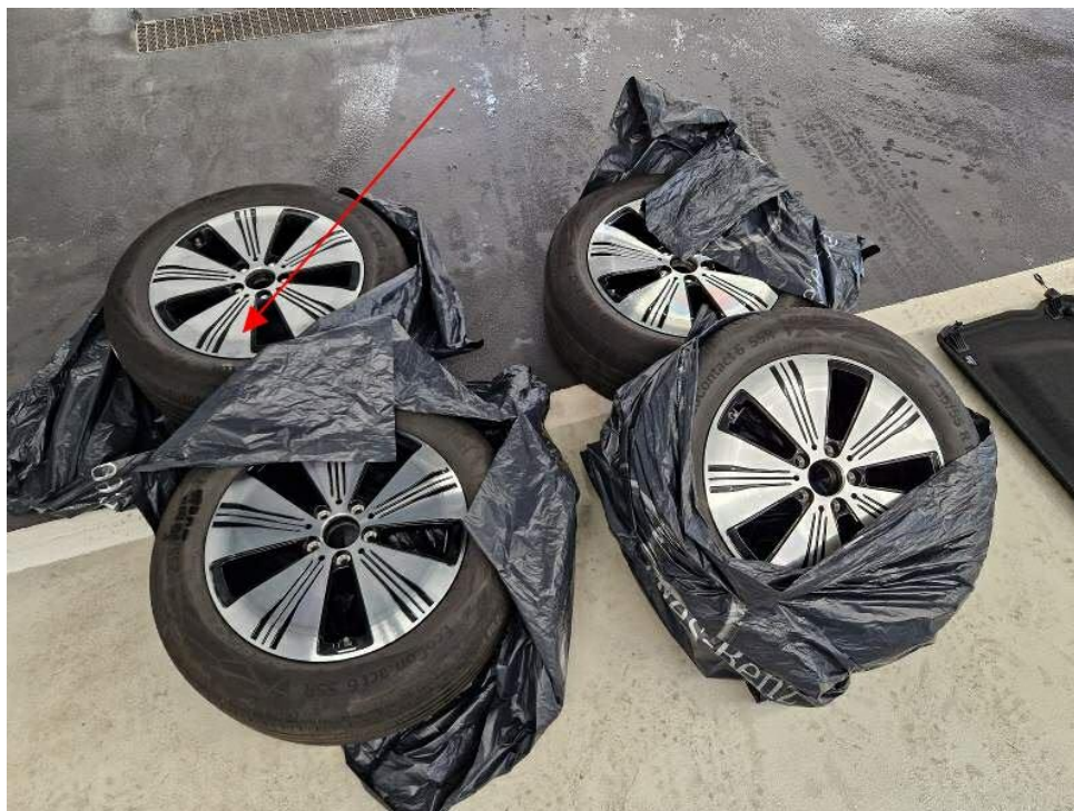
Bild 15 : Glanzgedrehte SR-Felge HR verschrammt
