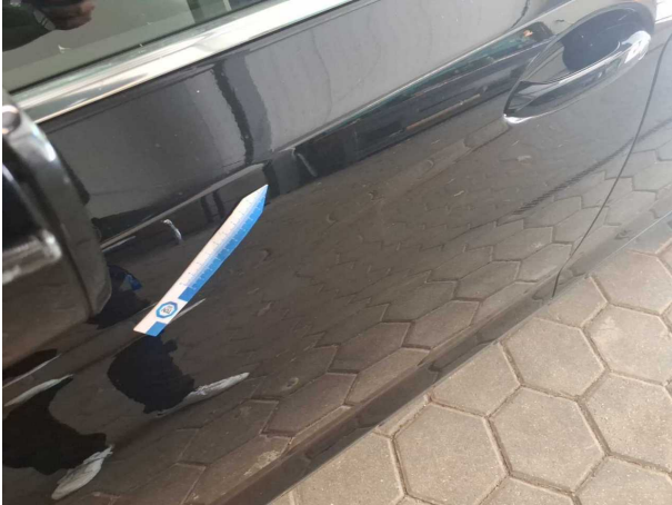
Beschädigung #1: Tür vorn links: Tür - Kratzer - auslegen / polieren
