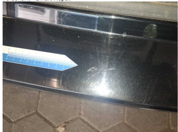
Beschädigung #8: Stossfänger hinten: Stossfänger hinten Mitte - verkratzt / verschürft - Smart Repair
