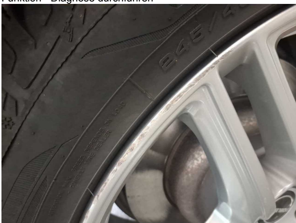
Beschädigung #11: Rad/Reifen: Leichtmetallfelge hinten rechts (Materialabrieb) - verkratzt / verschürft - erneuern
