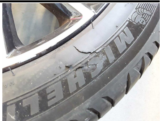
Beschädigung #5: 2.Radsatz: 1 Reifen - gebrochen / gerissen - erneuern
