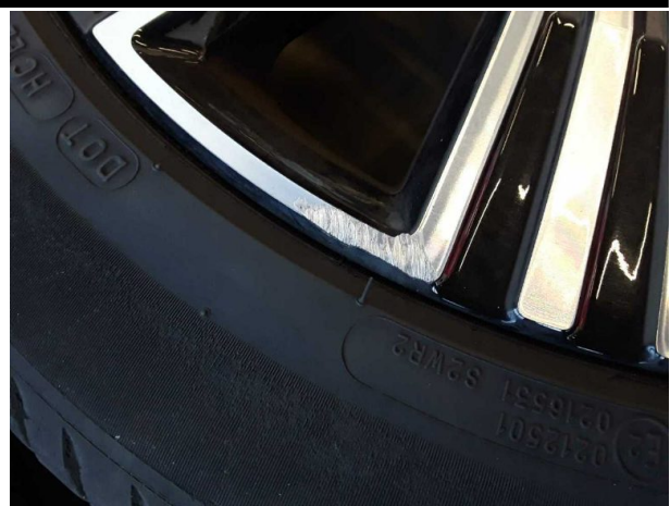
Beschädigung #7: 2.Radsatz: 2 Leichtmetallfelgen - verkratzt / verschürft - Wertminderung
