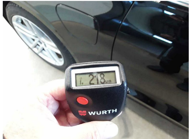
Nachlackierung 1: Tür hinten links, Tür vorne links
