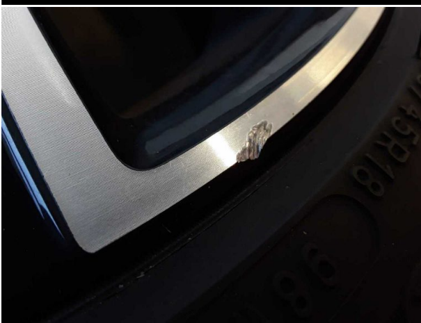
Beschädigung #7: 2.Radsatz: 2 Leichtmetallfelgen - verkratzt / verschürft - Wertminderung
