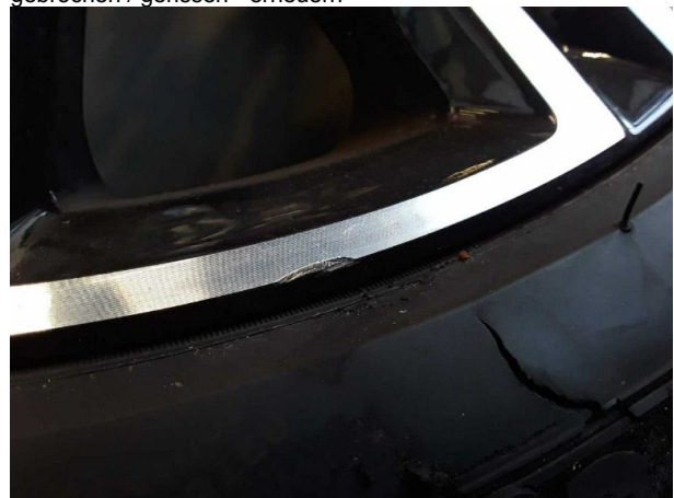
Beschädigung #7: 2.Radsatz: 2 Leichtmetallfelgen - verkratzt / verschürft - Wertminderung
