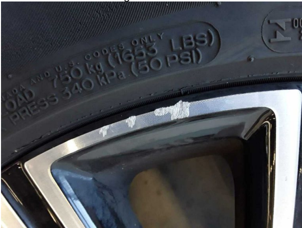
Beschädigung #7: 2.Radsatz: 2 Leichtmetallfelgen - verkratzt / verschürft - Wertminderung
