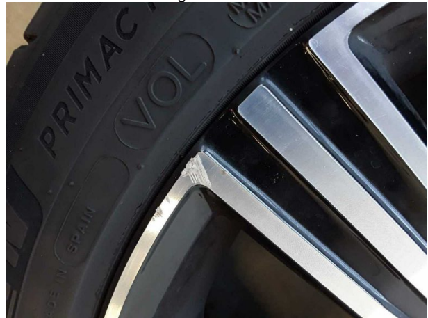
Beschädigung #7: 2.Radsatz: 2 Leichtmetallfelgen - verkratzt / verschürft - Wertminderung
