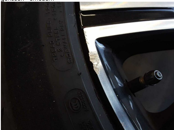
Beschädigung #7: 2.Radsatz: 2 Leichtmetallfelgen - verkratzt / verschürft - Wertminderung
