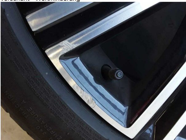
Beschädigung #7: 2.Radsatz: 2 Leichtmetallfelgen - verkratzt / verschürft - Wertminderung
