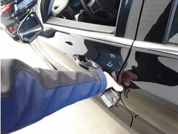
Nachlackierung 1: Tür hinten links, Tür vorne links
