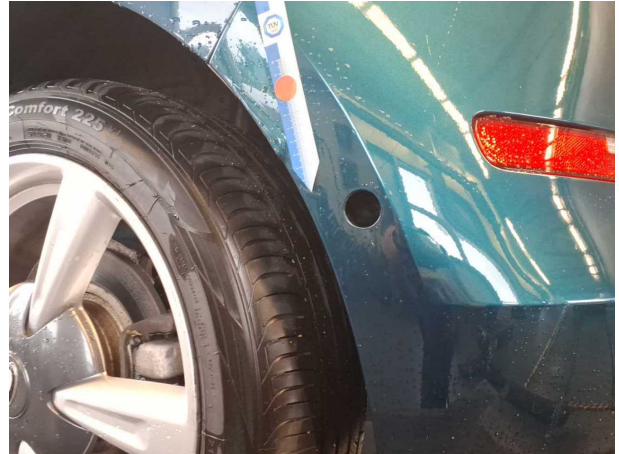
Beschädigung #1: Stossfänger hinten: Parksensoren links - lose - instandsetzen
