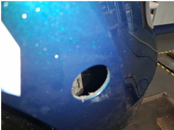
Beschädigung #1: Stossfänger hinten: Parksensoren links - lose - instandsetzen
