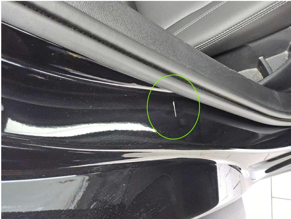
Bild 13 : Einstieg hinten rechts Kratzer
