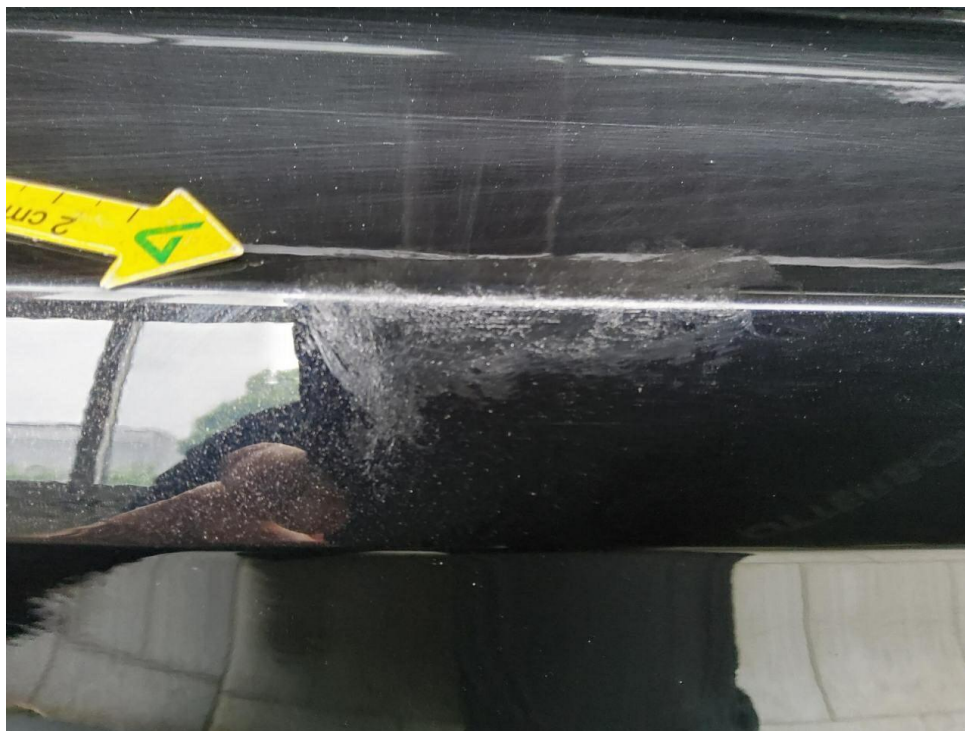
Bild 14 : Stoßfänger hinten Lackierung, zerkratzt, smart repair
