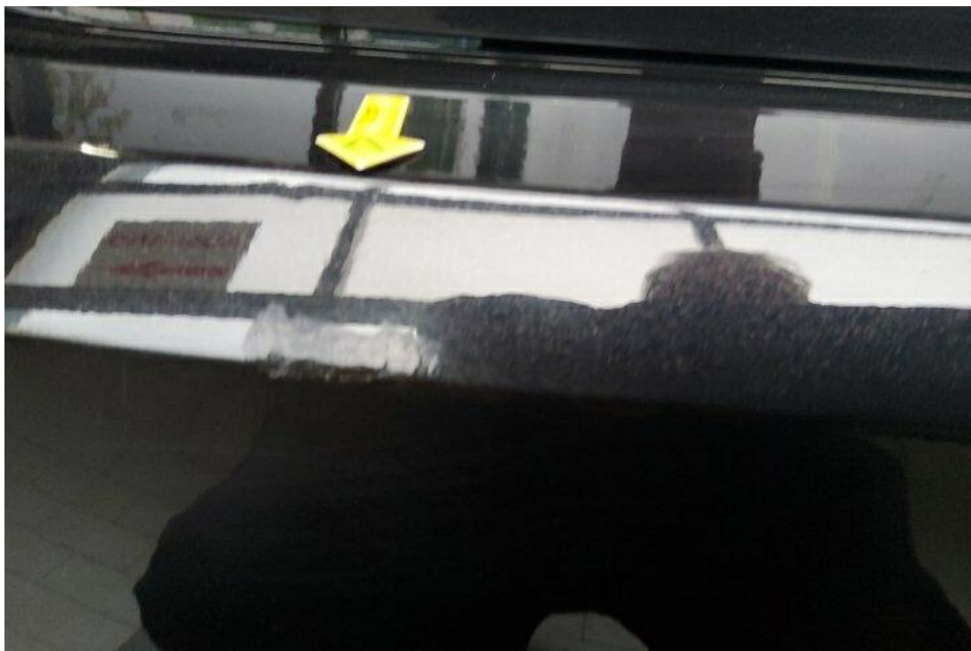
Bild 13 : Stoßfänger hinten Lackierung, zerkratzt, smart repair
