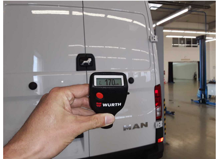
Boot lid / rear door: 170 µm
