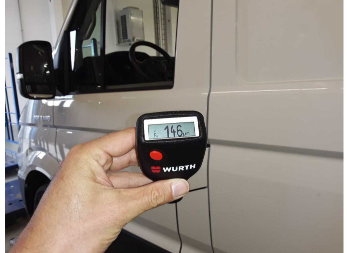
Door - front left side: 146 µm
