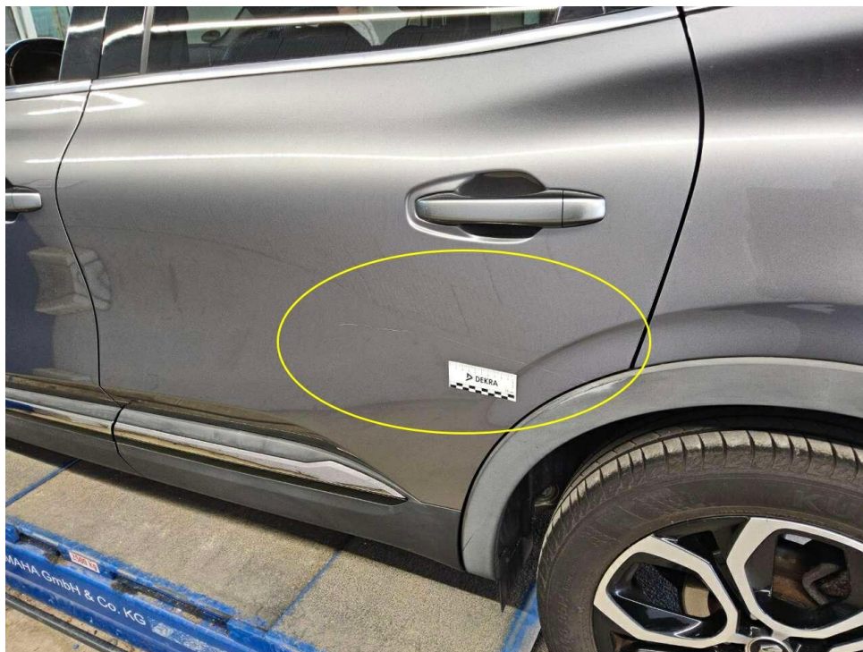
Bild 17 : Tür hinten links Lackierung, verschrammt, lackieren mit Lackaufbau
