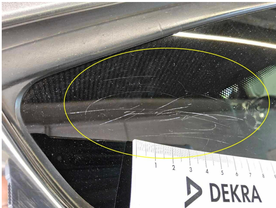
Bild 31 : Seitenfenster hinten rechts zerkratzt
