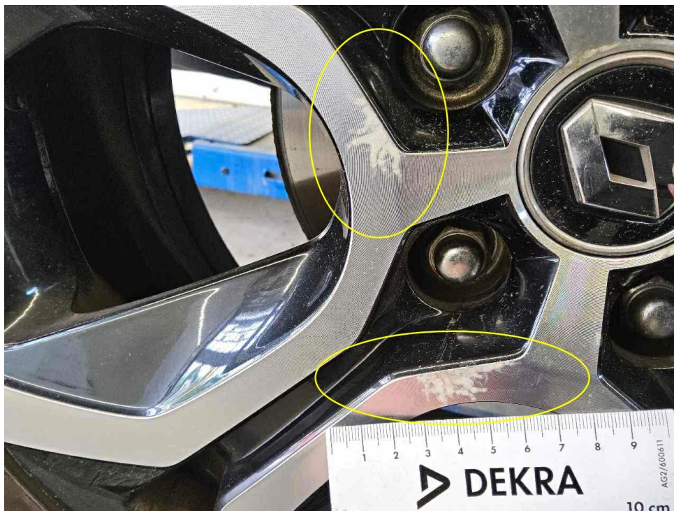
Bild 39 : LM Felge hinten rechts glanzgedreht korrodiert
