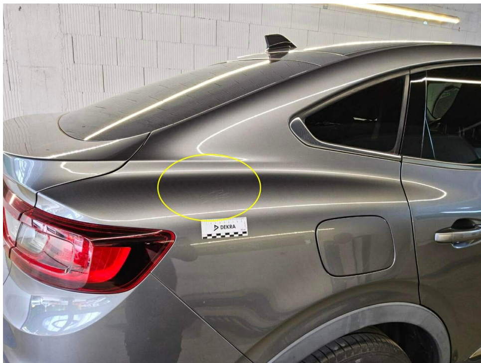
Bild 13 : Seitenteil hinten rechts Lackierung, verschrammt, lackieren mit Lackaufbau
