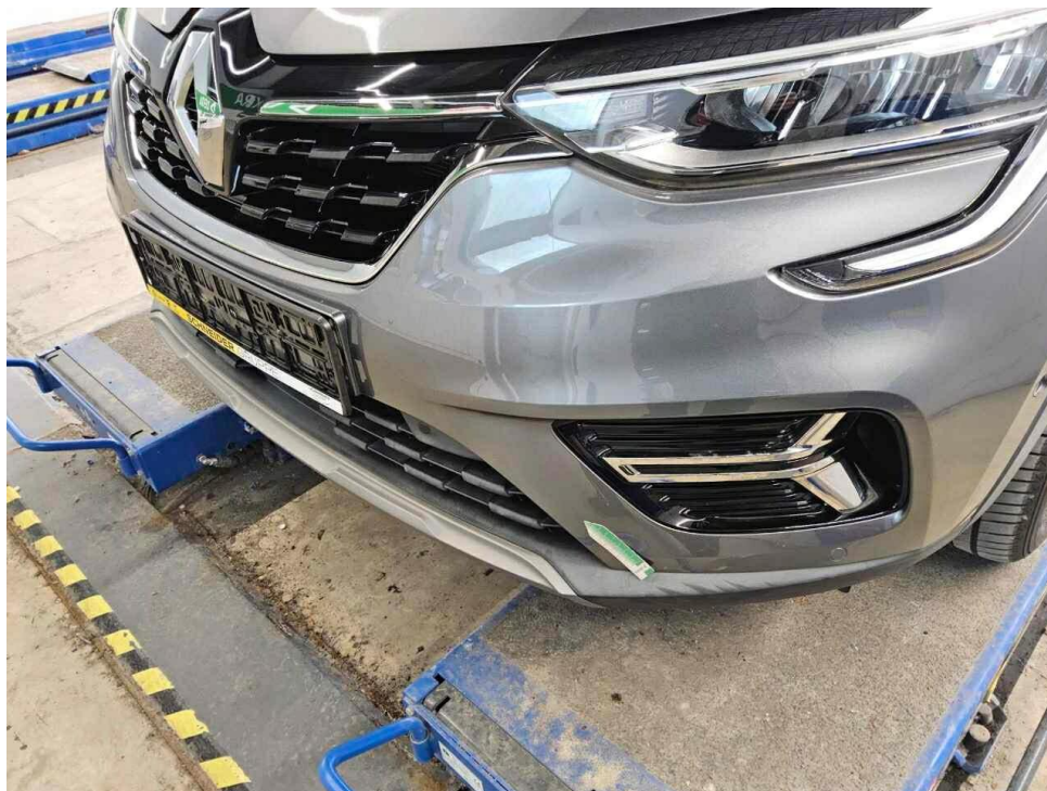
Bild 25 : Stoßfänger vorne Lackierung, Steinschlag, Gebrauchsspur
