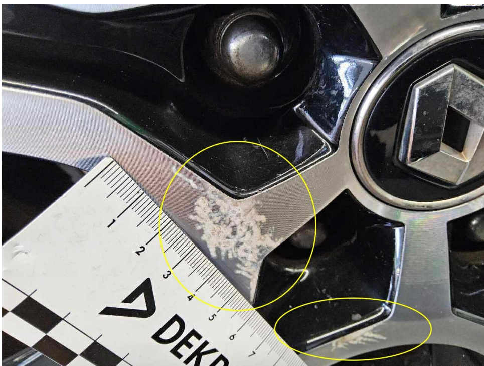
Bild 38 : LM Felge vorne rechts glanzgedreht, korrodiert
