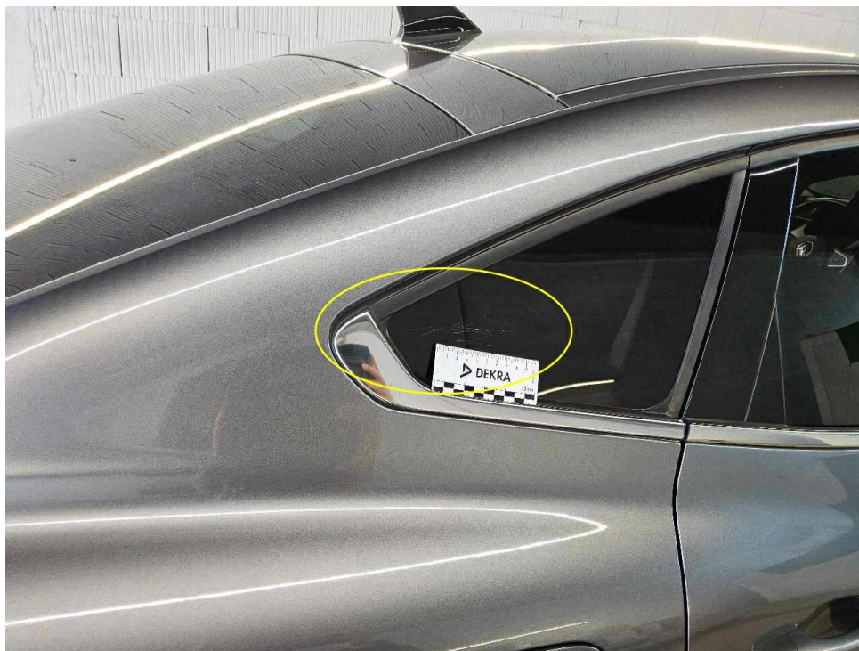
Bild 32 : Seitenfenster hinten rechts zerkratzt
