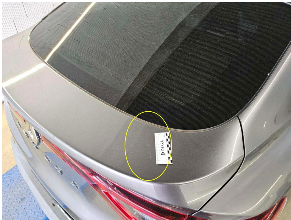
Bild 15 : Heckklappe Lackierung, verschrammt, lackieren mit Lackaufbau
