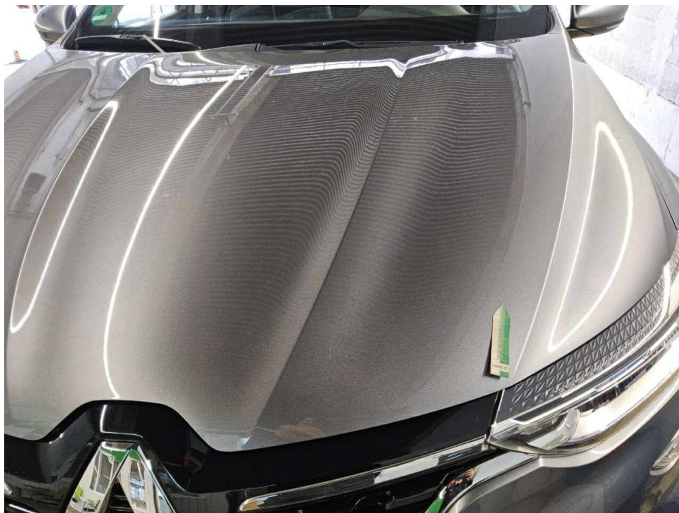
Bild 27 : Motorhaube Lackierung, Steinschlag, Gebrauchsspur
