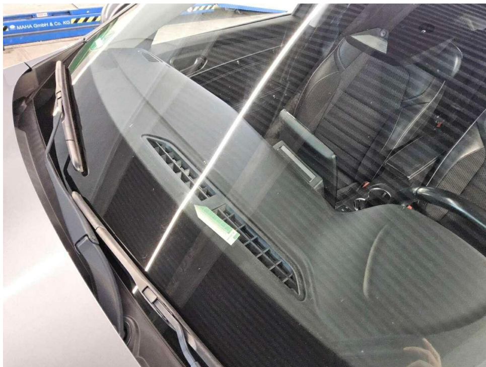
Bild 29 : Frontscheibe, Steinschlag, Gebrauchsspur
