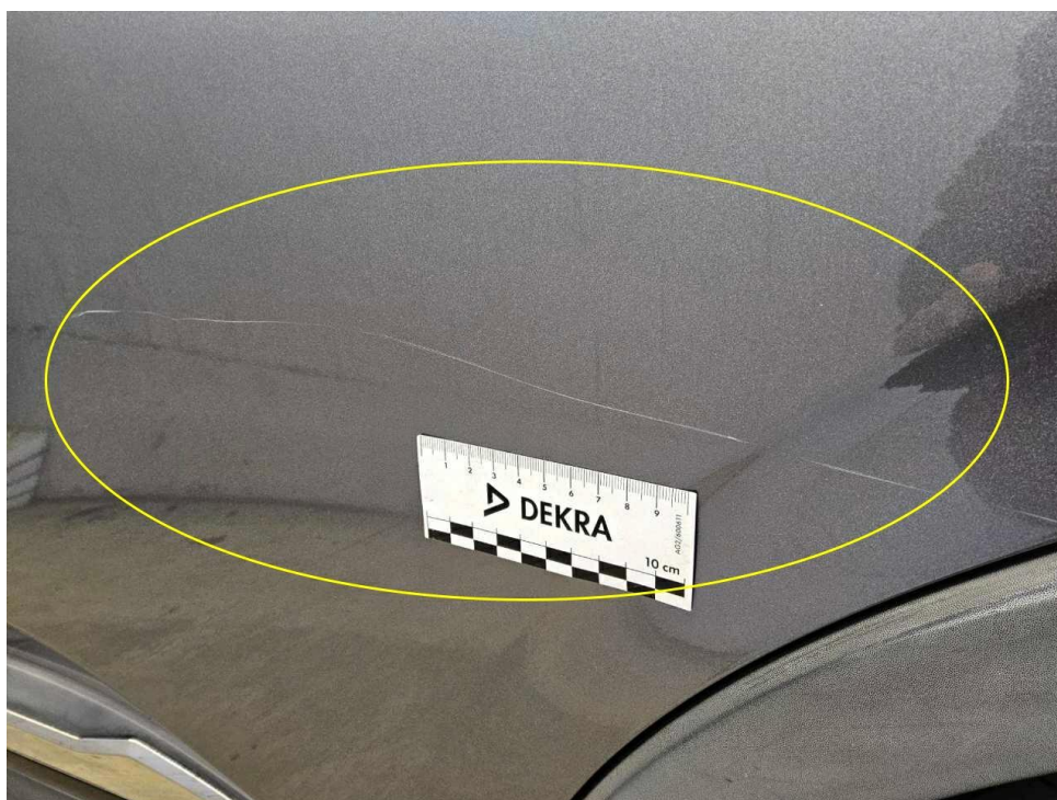
Bild 18 : Tür hinten links Lackierung, verschrammt, lackieren mit Lackaufbau
