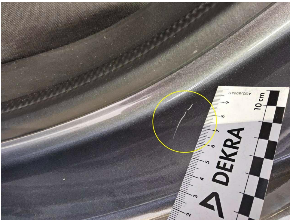
Bild 20 : Tür hinten links Einstieg, zerkratzt, smart repair
