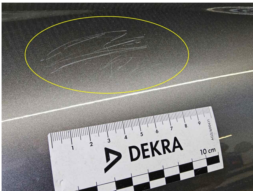
Bild 14 : Seitenteil hinten rechts Lackierung, verschrammt, lackieren mit Lackaufbau
