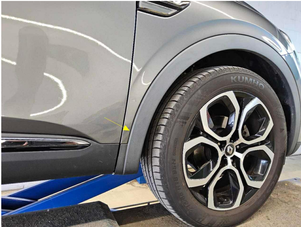
Bild 37 : Nicht lackierte Kunststoffleisten, Radläufe und Stoßfänger vorne und hinten ausgeblichen
