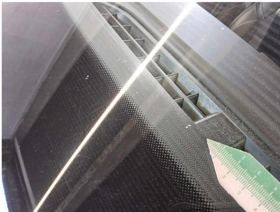
Bild 30 : Frontscheibe, Steinschlag, Gebrauchsspur
