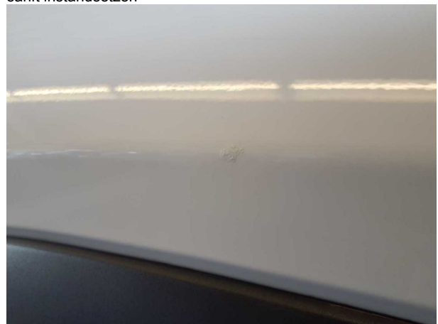
Beschädigung #5: Seitenwand links: Seitenwand (mit Lackmangel) - nicht fachgerecht instandgesetzt - lackieren
