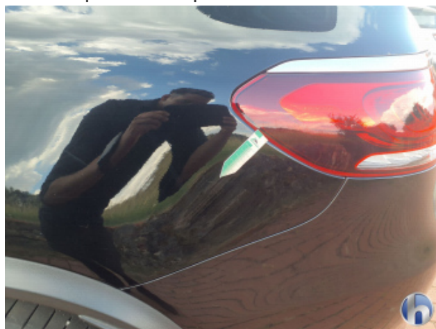
2. Seitenwand - Hinten - Links Kratzer - Lackieren
