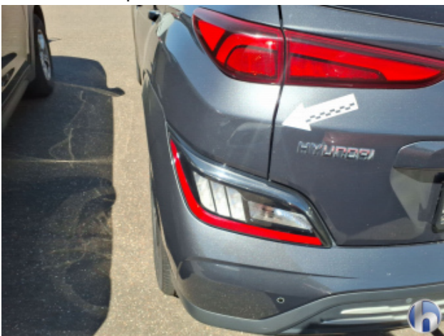
3. Seitenwand - Hinten - Links Kratzer - Smart Repair
