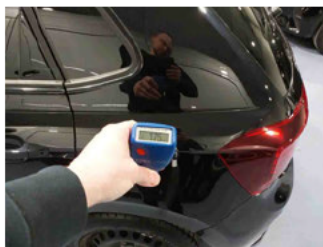
Lackstärke Seitenwand hinten links
