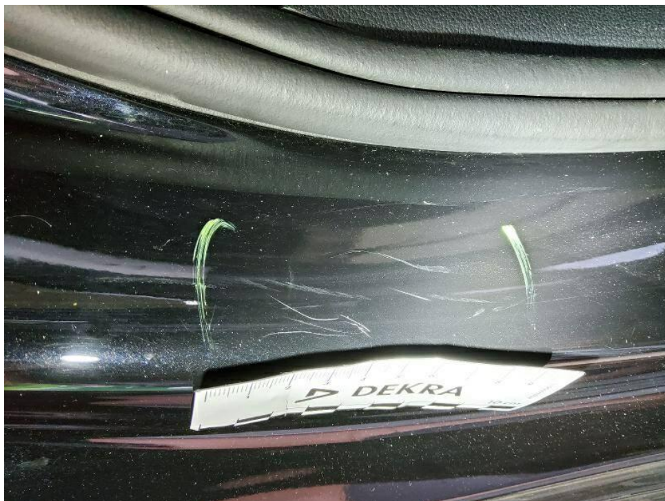
Bild 20 : Einstiegsschweller hinten rechts kleine Kratzer
