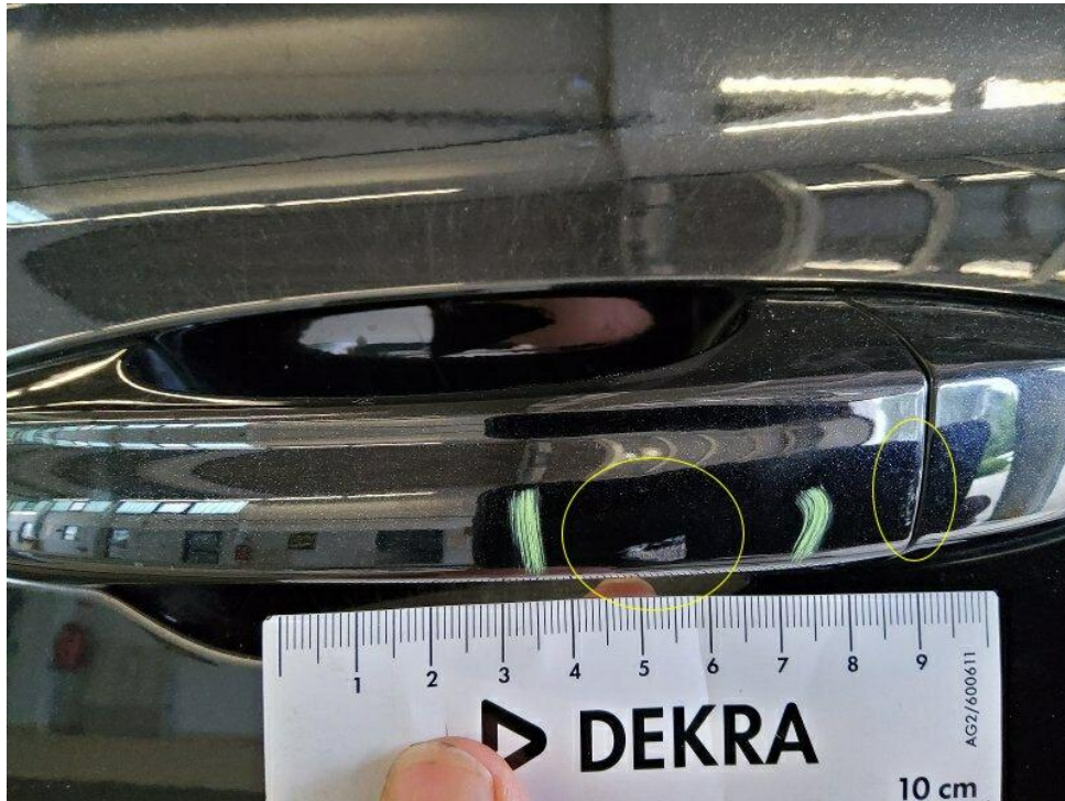
Bild 33 : Türgriff vorne links außen verschrammt
