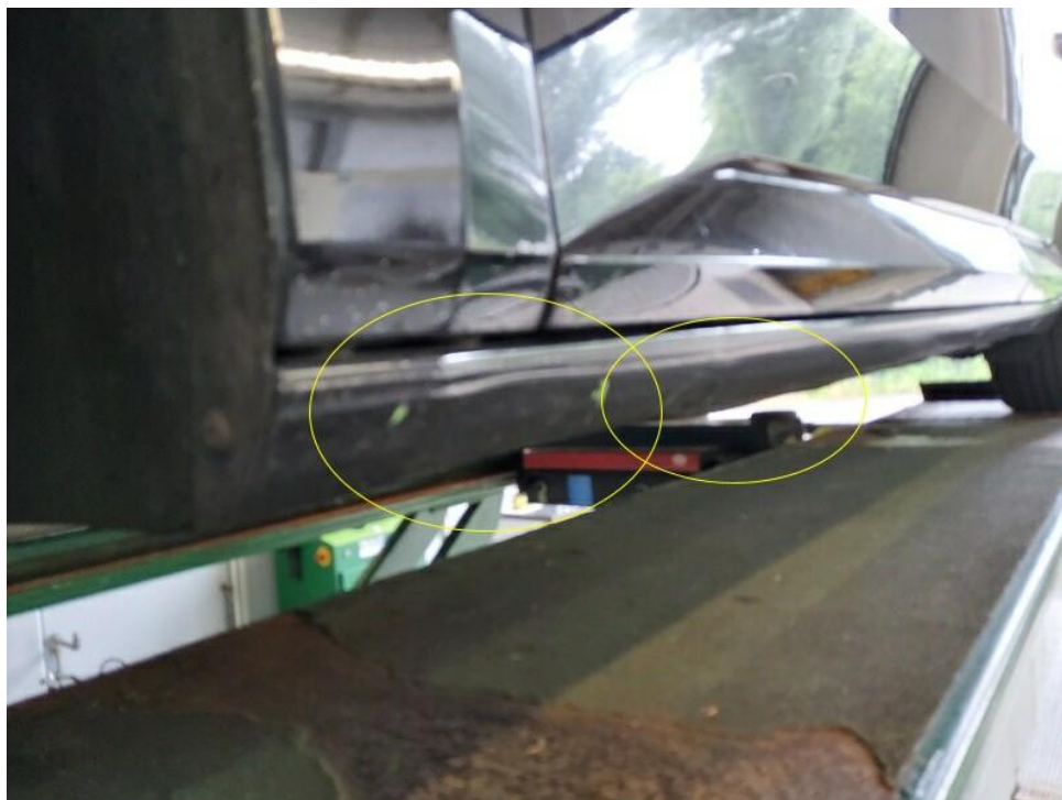
Bild 44 : Außenschweller vorne links mehrfach leicht eingedrückt
