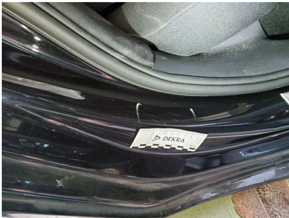
Bild 19 : Einstiegsschweller hinten rechts kleine Kratzer
