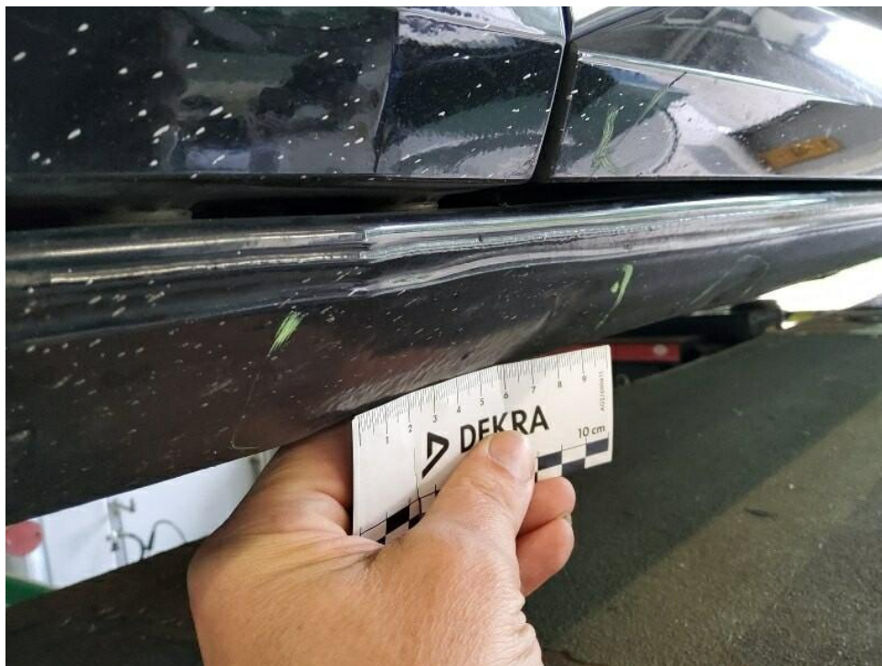
Bild 45 : Außenschweller vorne links mehrfach leicht eingedrückt
