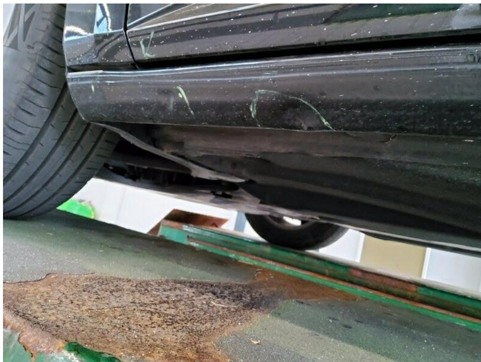
Bild 46 : Außenschweller vorne links mehrfach leicht eingedrückt
