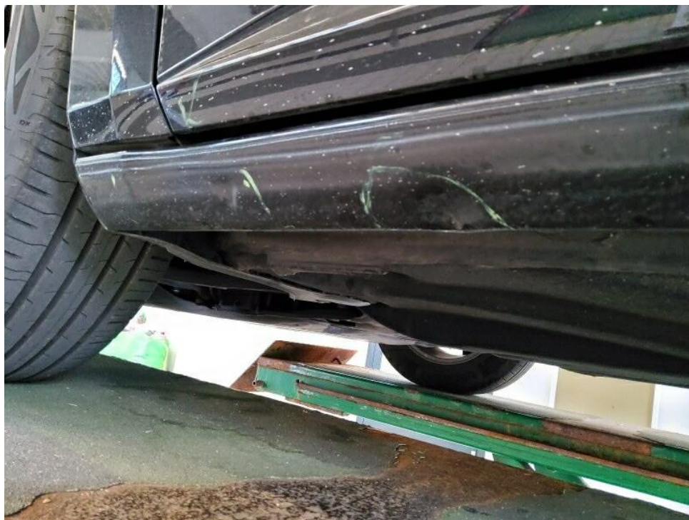
Bild 49 : Außenschweller vorne links mehrfach leicht eingedrückt
