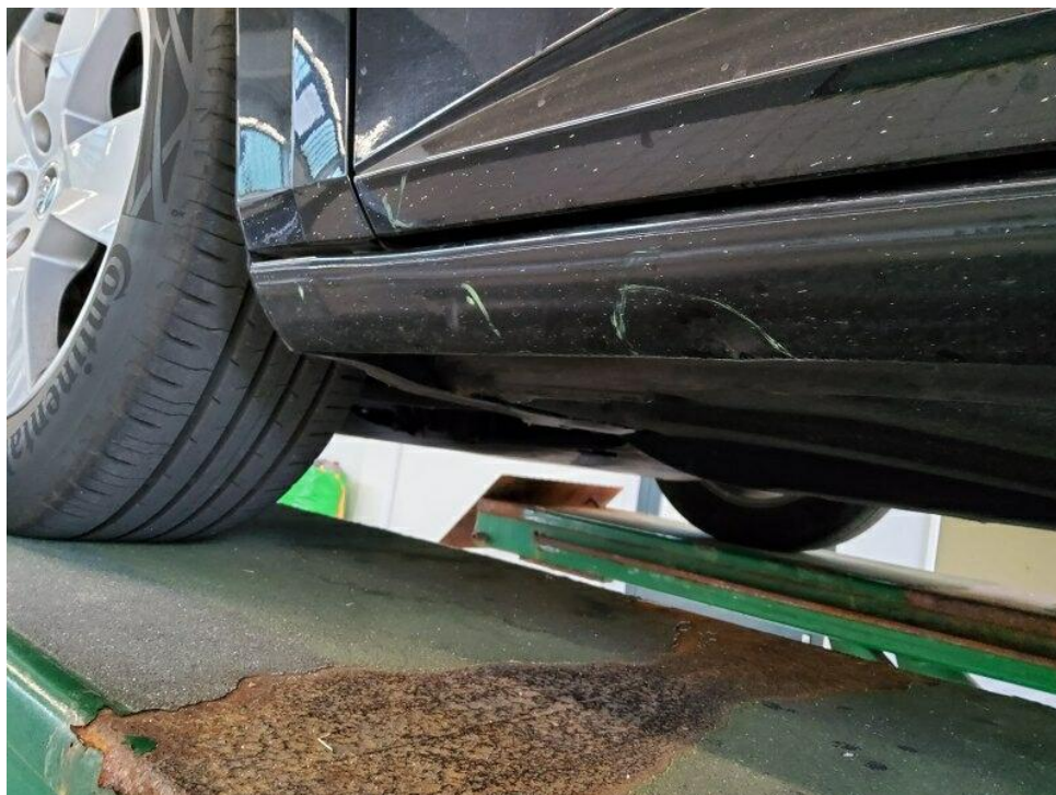
Bild 48 : Außenschweller vorne links mehrfach leicht eingedrückt
