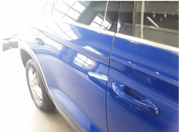
Beschädigung #9: Tür hinten rechts: Tür - Delle(n) - instandsetzen und lackieren
