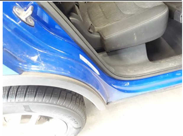
Beschädigung #5: Seitenwand rechts: Einstieg - Kratzer - Smart Repair
