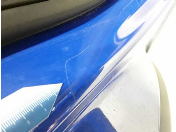
Beschädigung #5: Seitenwand rechts: Einstieg - Kratzer - Smart Repair
