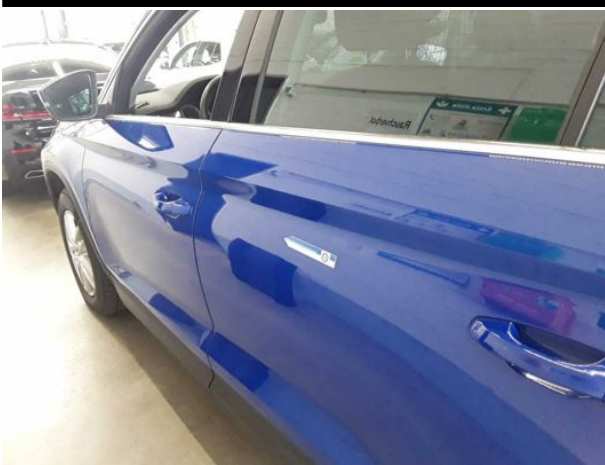
Beschädigung #8: Tür hinten links: Tür - Delle / Lackschaden - instandsetzen und lackieren
