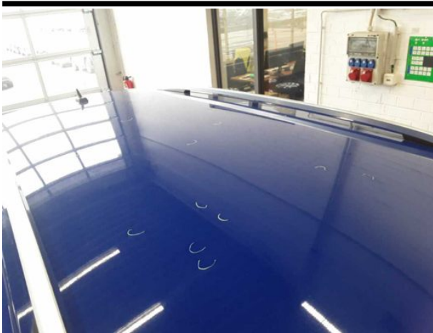
Beschädigung #13: Fahrzeugdach: Dach (Hagelschaden) - Delle(n) - sanft instandsetzen
