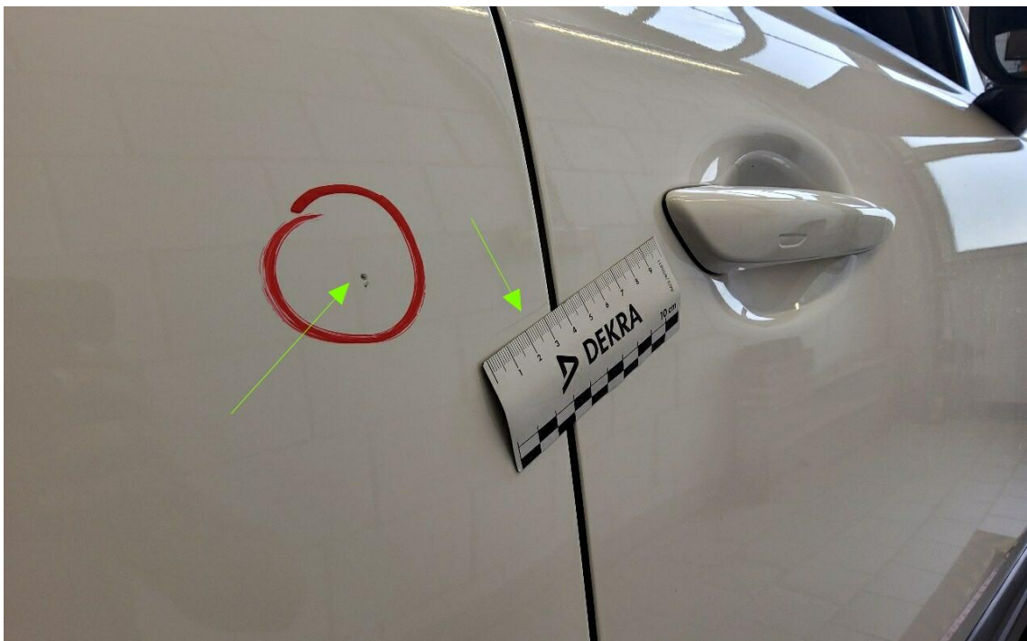
Bild 14 : Tür hinten rechts Kratzer
