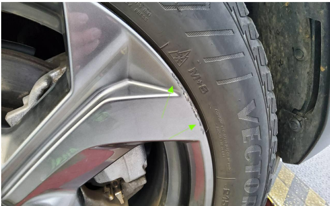
Bild 16 : Alufelge vorne rechts verschrammt
