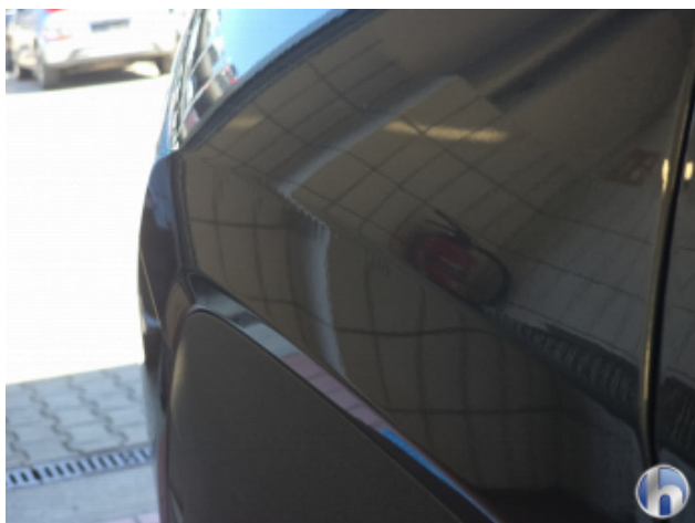
10. Seitenwand - Hinten - Rechts Unsachgemäß Instandgesetzt - Instandsetzen und Lackieren
