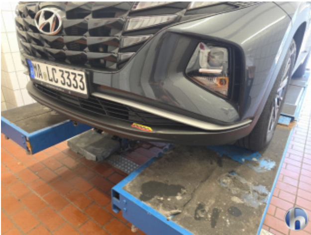
12. Frontspoiler Beschädigt - Erneuern
