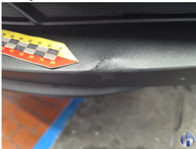
12. Frontspoiler Beschädigt - Erneuern
