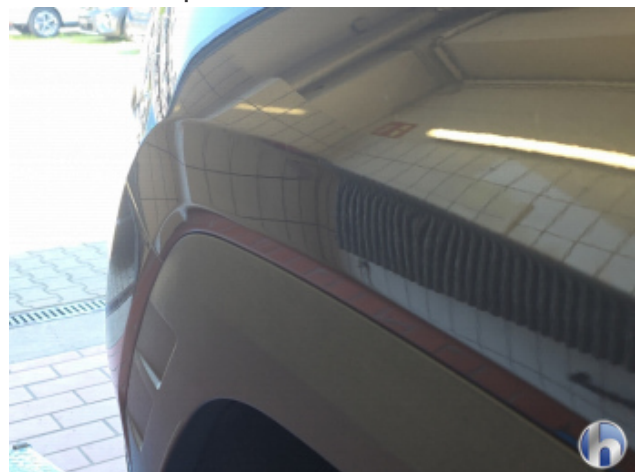
10. Seitenwand - Hinten - Rechts Unschadgemäß Instandgesetzt - Instandsetzen und Lackieren
