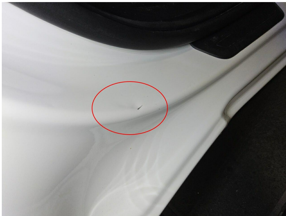
Bild 7 : Türeinstieg hinten rechts verkratzt und eingedellt
