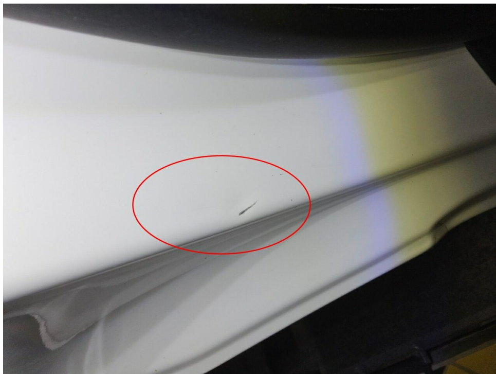
Bild 8 : Türeinstieg hinten rechts verkratzt und eingedellt
