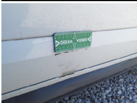
Baguette de porte / Avant Droit / Rayure
