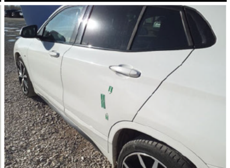
Porte / Arrière Gauche / Enfoncement
