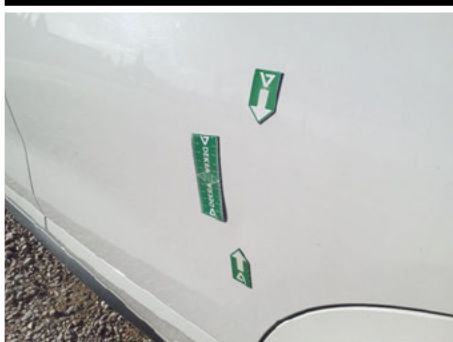
Porte / Arrière Gauche / Enfoncement
