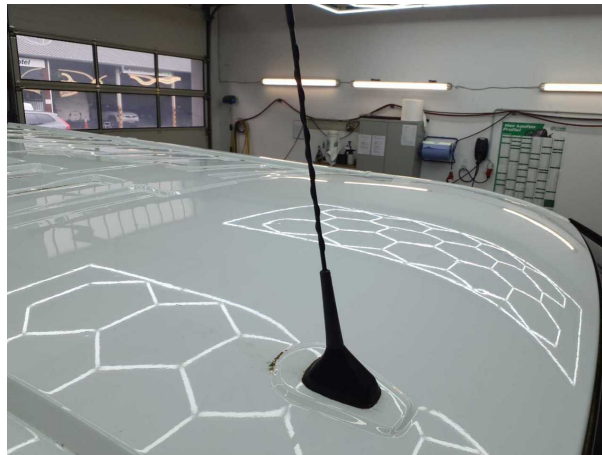
Beschädigung #3: Fahrzeugdach: Dach - Hagelschaden - instandsetzen und lackieren
