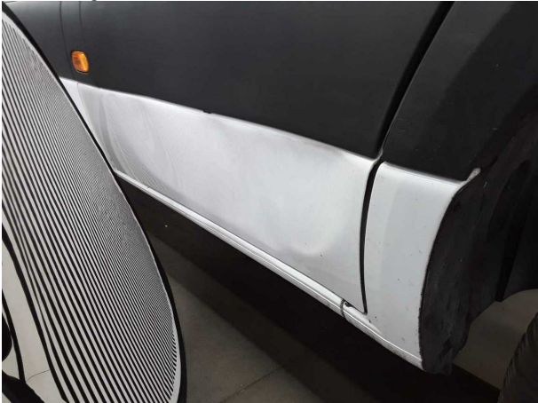
Beschädigung #17: Tür vorn rechts: Tür - verformt - erneuern
