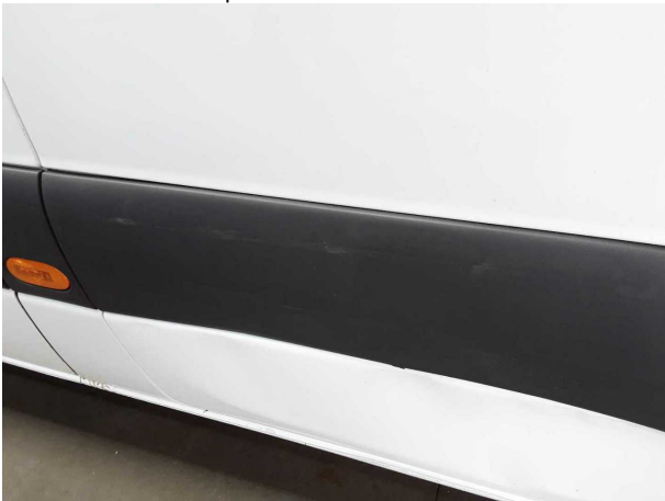
Beschädigung #3: Tür vorn rechts: Zierleiste unten - verformt - erneuern
