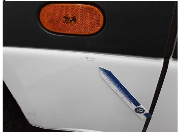
Beschädigung #4: Seitenwand rechts: Seitenwand - verkratzt / verschürft - Smart Repair
