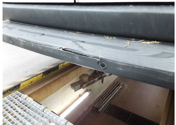
Beschädigung #12: Stossfänger hinten: Verkl. Stossfänger Auftritt mit Parktronic (Mehrkosten können entstehen) - gebrochen /
