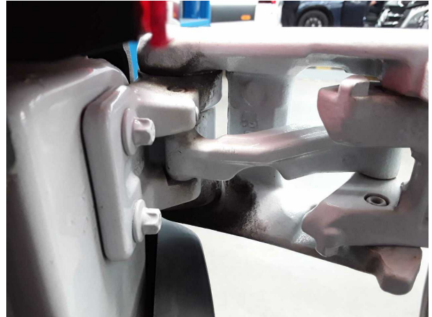
Beschädigung #8: Heckklappe/-tür: Scharnier unten (270 Grad) (Rechts) - verformt - erneuern
