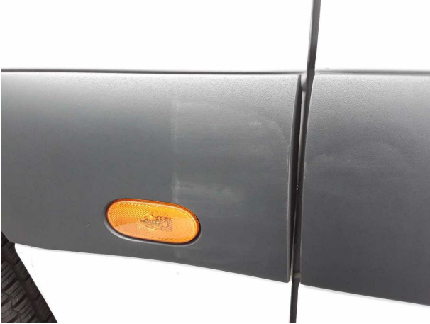
Beschädigung #1: Seitenwand rechts: Schutzleiste - verkratzt / verschürft - Smart Repair
