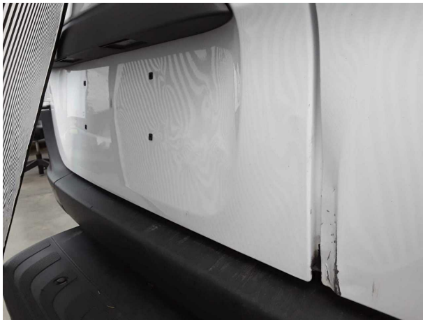
Beschädigung #11: Heckklappe/-tür: Hecktür links - Delle / Lackschaden - Smart Repair
