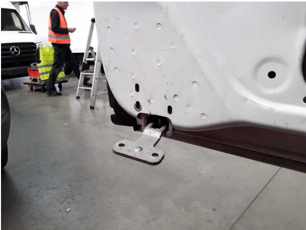
Beschädigung #5: Heckklappe/-tür: Hecktürschloss unten (Mehrkosten... können entstehen) - ohne Funktion - erneuern
