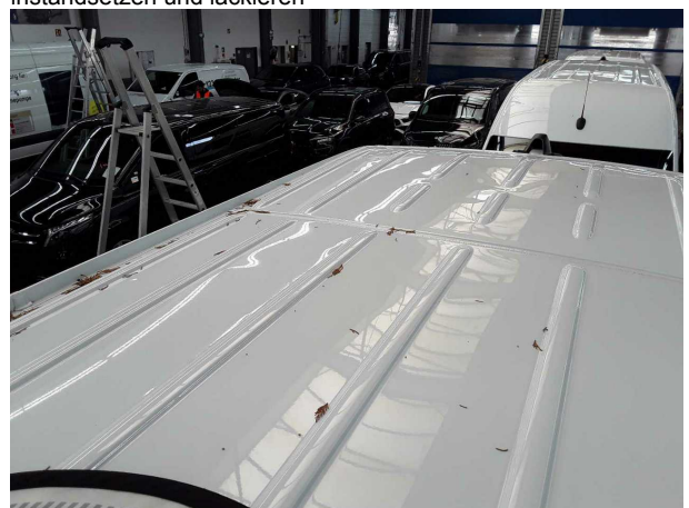
Beschädigung #15: Fahrzeugdach: Dach - Delle / Lackschaden - instandsetzen und lackieren
