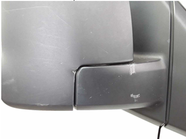
Beschädigung #13: Außenspiegel rechts: Außenspiegel - beschädigt - erneuern
