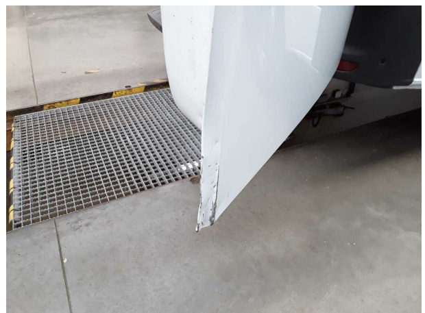
Beschädigung #18: Heckklappe/-tür: Hecktür rechts - verformt - erneuern
