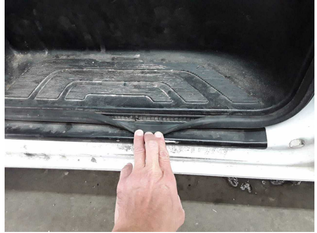
Beschädigung #2: Tür vorn links: Türdichtung - gebrochen / gerissen - erneuern
