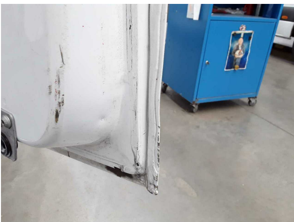
Beschädigung #18: Heckklappe/-tür: Hecktür rechts - verformt - erneuern
