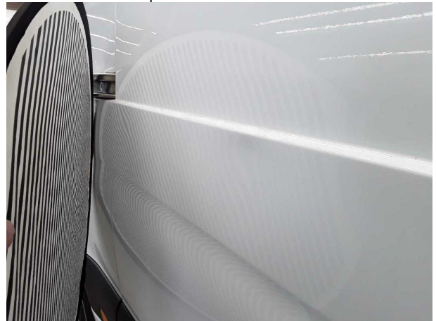
Beschädigung #6: Schiebetür rechts: Schiebetür - Delle / Lackschaden - Smart Repair
