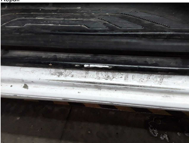
Beschädigung #10: Schweller links: Einstieg - verkratzt / verschürft - lackieren
