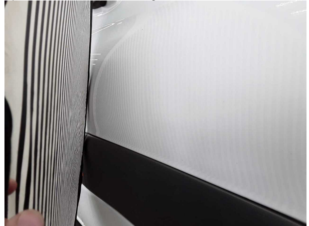
Beschädigung #17: Tür vorn rechts: Tür - verformt - erneuern
