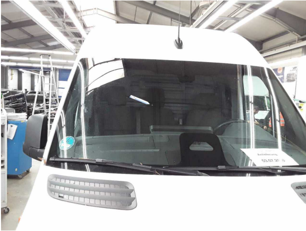
Beschädigung #16: Verglasung: Frontscheibe mit Spurhalteassistent - Steinschlag - erneuern
