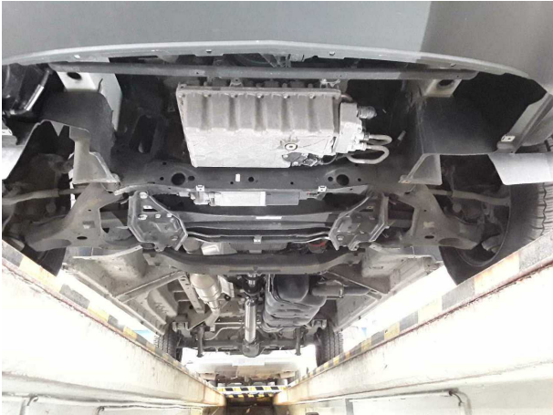
Beschädigung #7: Motor: Motorverkleidung unten - fehlt - erneuern
