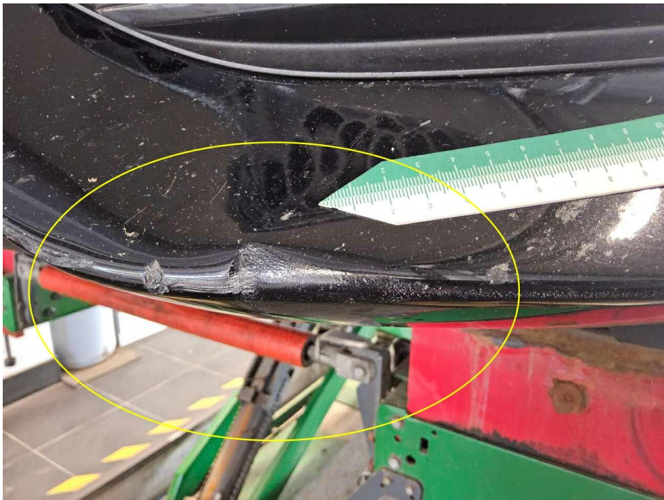
Bild 20 : Frontschaden, verformt und verschrammt
