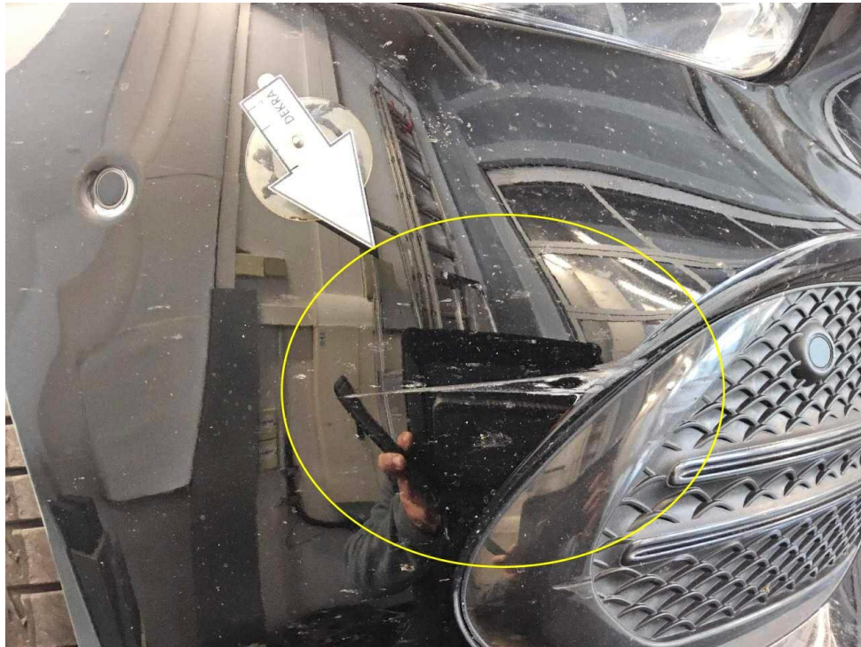
Bild 17 : Frontschaden, verformt und verschrammt
