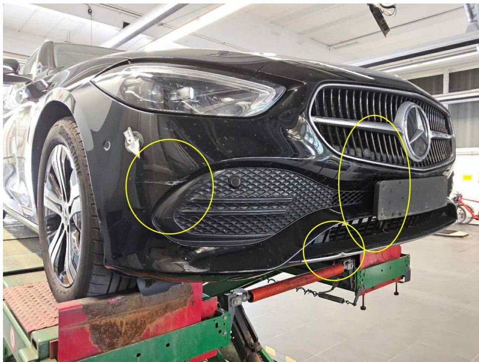
Bild 16 : Frontschaden, verformt und verschrammt
