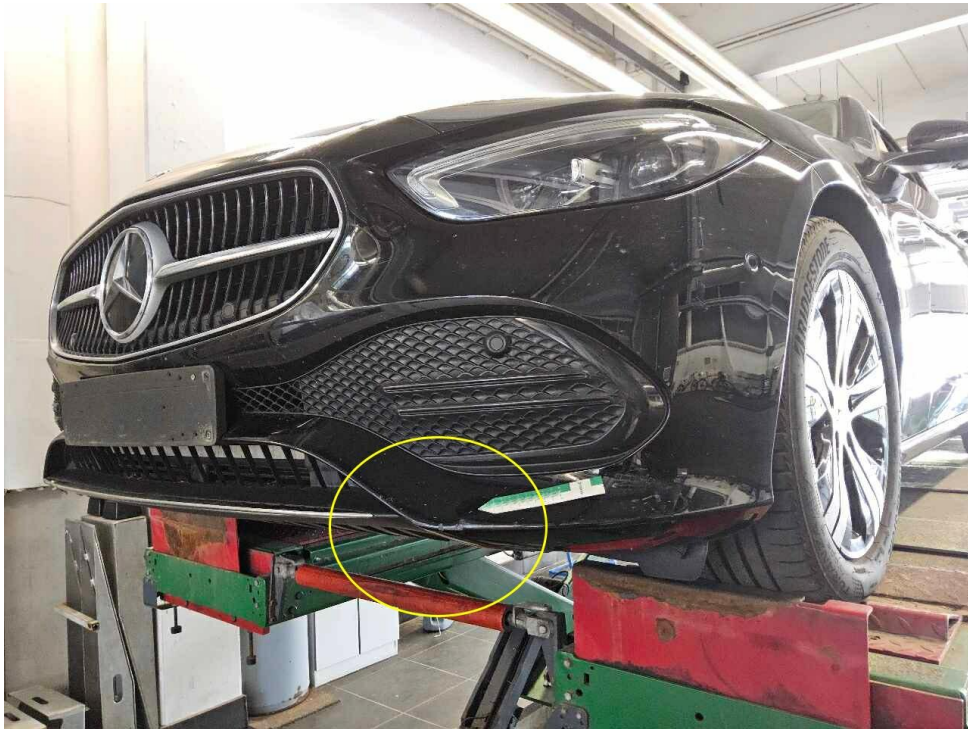
Bild 19 : Frontschaden, verformt und verschrammt
