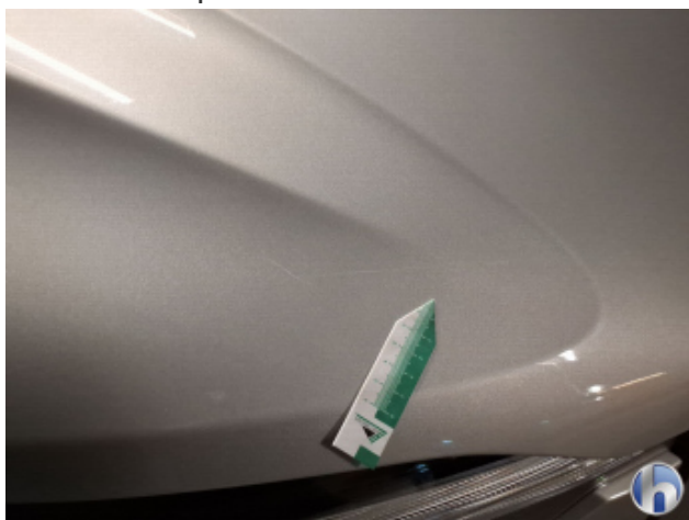
3. Motorhaube Kratzer - Lackieren
