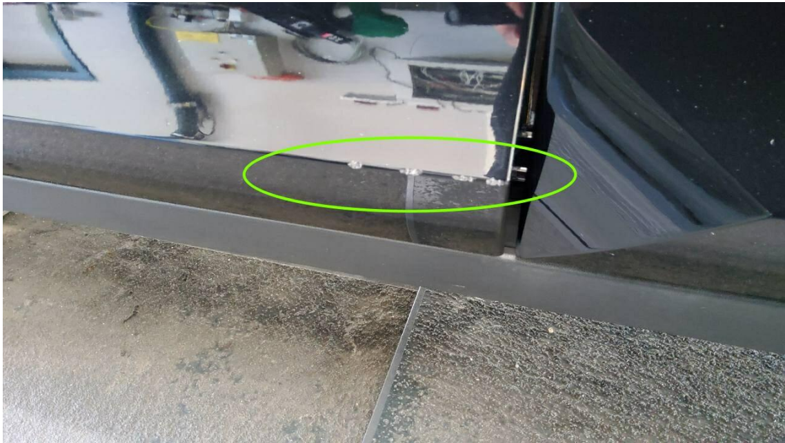
Bild 21 : Zierleiste Tür vorn links - verkratzt
