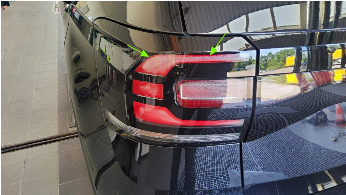
Bild 13 : Heckleuchte links - undicht
