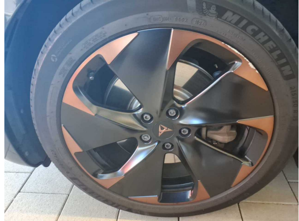
Beschädigung #3: Rad/Reifen: Leichtmetallfelge vorn links (Materialabrieb) - verkratzt / verschürft - erneuern
