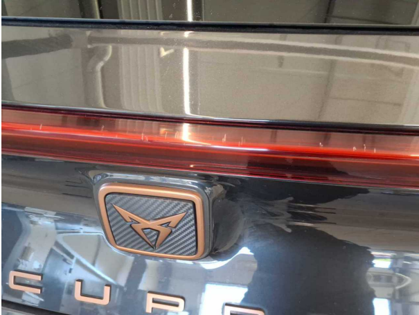
Beschädigung #2: Heckleuchte: Zusatzbremsleuchte (Mitte) - verkratzt / verschürft - erneuern
