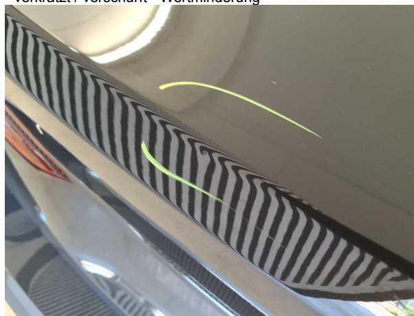
Beschädigung #5: Heckklappe/-tür: Heckklappe - Delle / Lackschaden - Smart Repair
