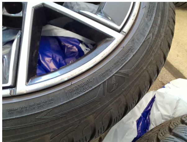
Beschädigung #1: 2.Radsatz: 2 Leichtmetallfelgen - verkratzt / verschürft - kein Abzug
