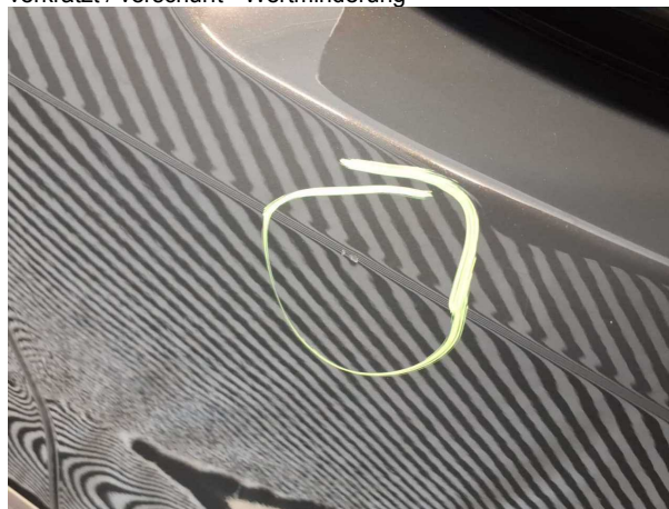
Beschädigung #3: Tür vorn rechts: Tür - Delle / Lackschaden - Smart Repair
