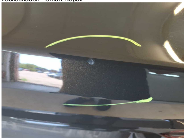
Beschädigung #5: Heckklappe/-tür: Heckklappe - Delle / Lackschaden - Smart Repair
