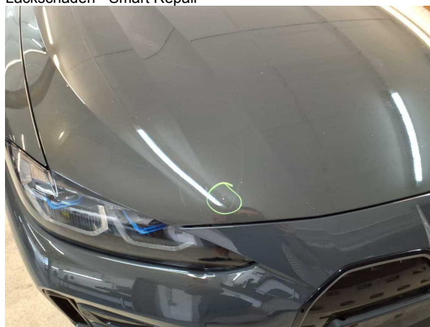
Beschädigung #6: Motorhaube: Motorhaube - Delle / Lackschaden - instandsetzen und lackieren
