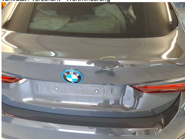
Beschädigung #5: Heckklappe/-tür: Heckklappe - Delle / Lackschaden - Smart Repair
